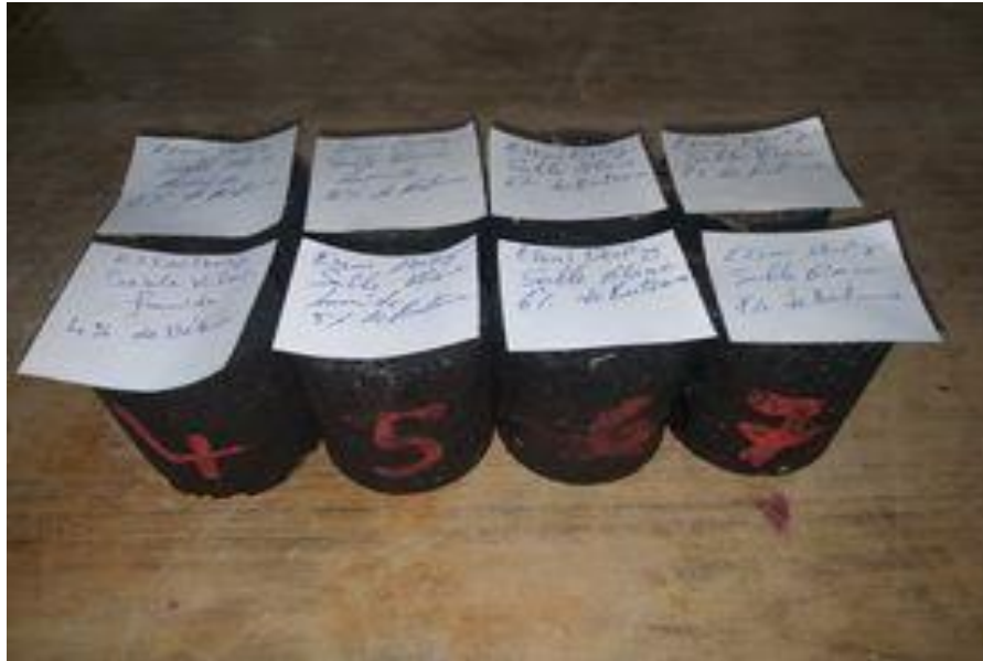
Photo (V.10) : La préparation des éprouvettes pour l'essai ultrasonique
