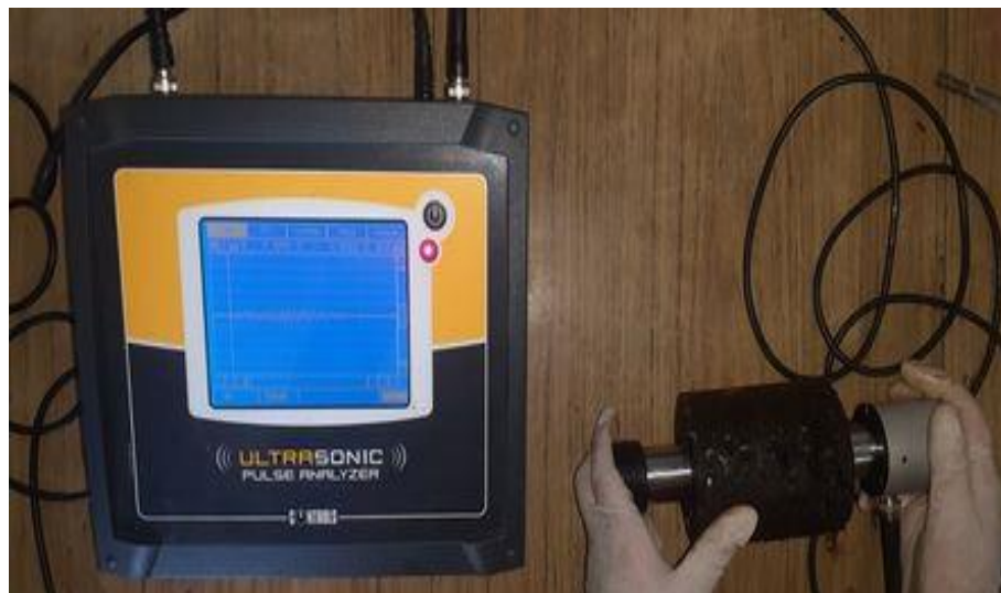
Photo (V.11) : Temps des ondes ultrasoniques sur des éprouvettes
