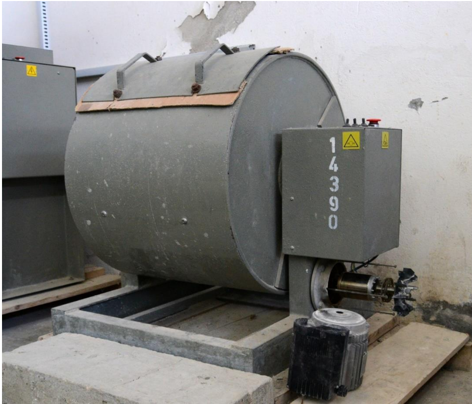
Photo (IV.3) : Machine de l'essai Los Angeles
