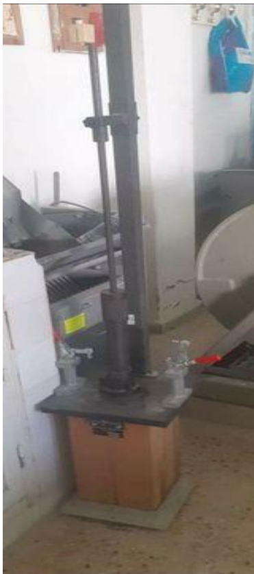
Photo (V.4) : Opération de compactage
