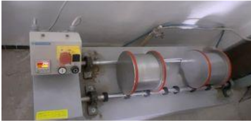
Photo (IV.5) : Machine de l'essai micro deval en présence d'eau
