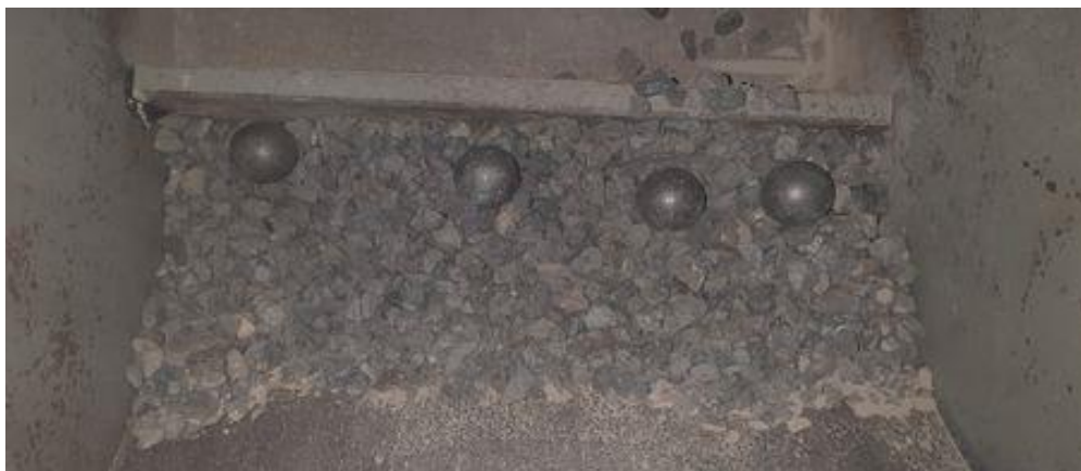
Photo (IV.4) : Les boules de purée de l'essai Los Angeles
