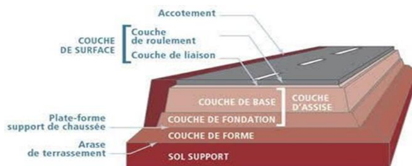
Figure (III.1) : structure d'une chaussée
