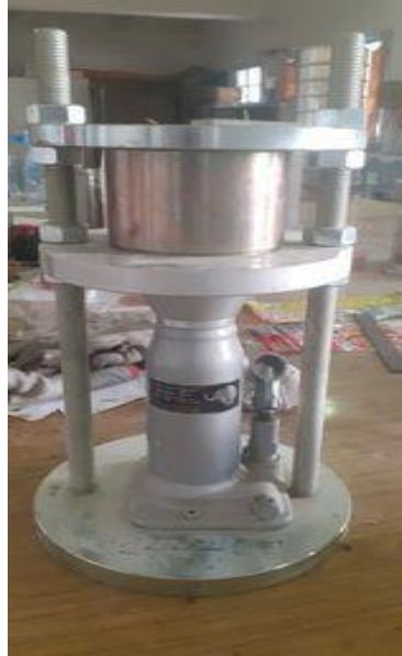
Photo (V.6) : Opération de démoulage
