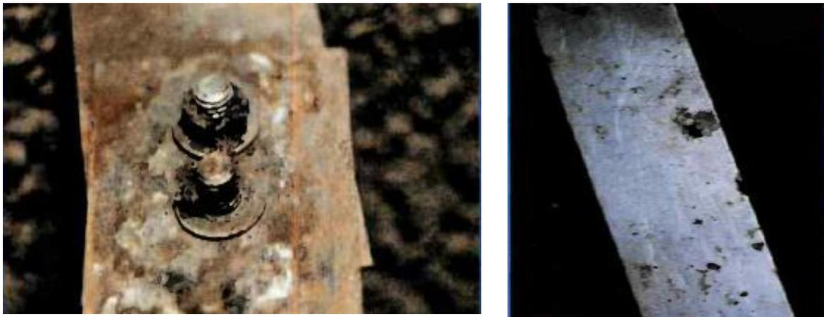
**Figure 2.18 :** Corrosion des renforcements métalliques (SETRA, 1994).
