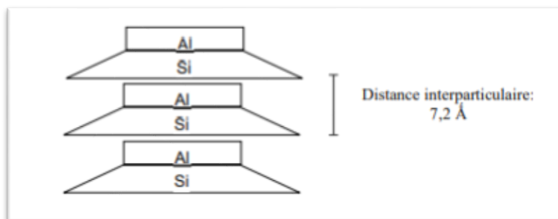
Figure 2.5 : Structure de la particule de kaolinite (Si 4 O 10 ) Al 4 (OH) 8
