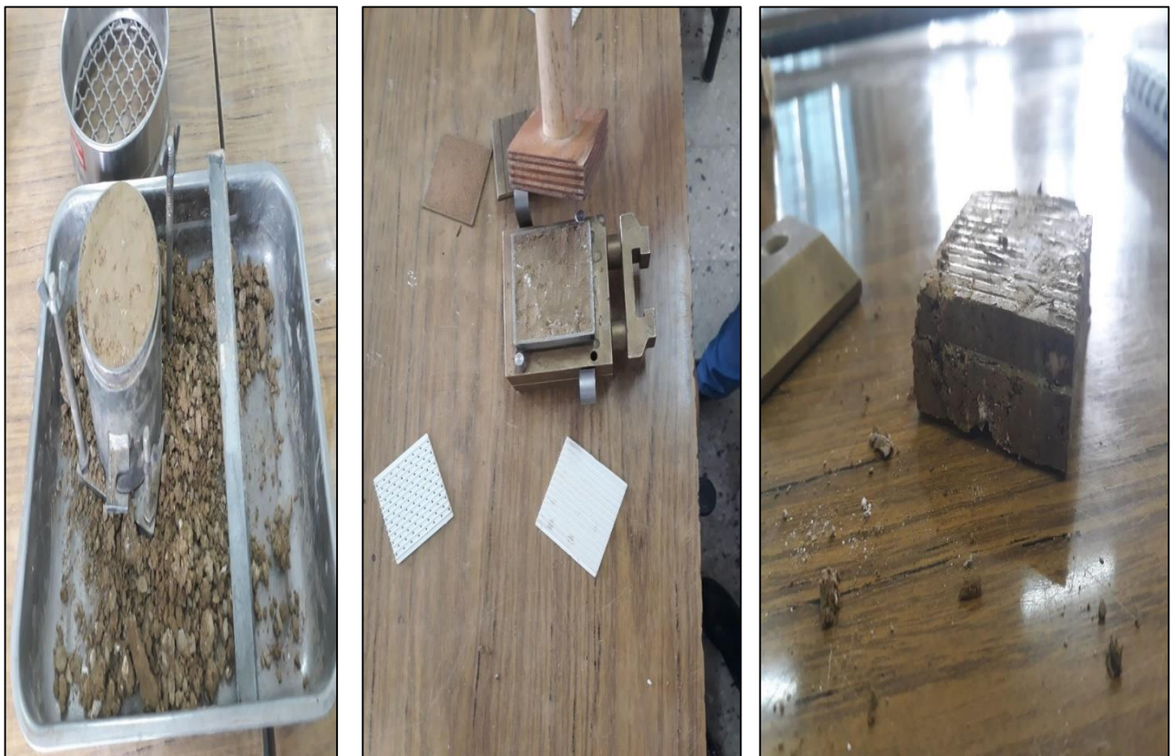
Figure 5.44 : les étapes de l'essai de cisaillement
