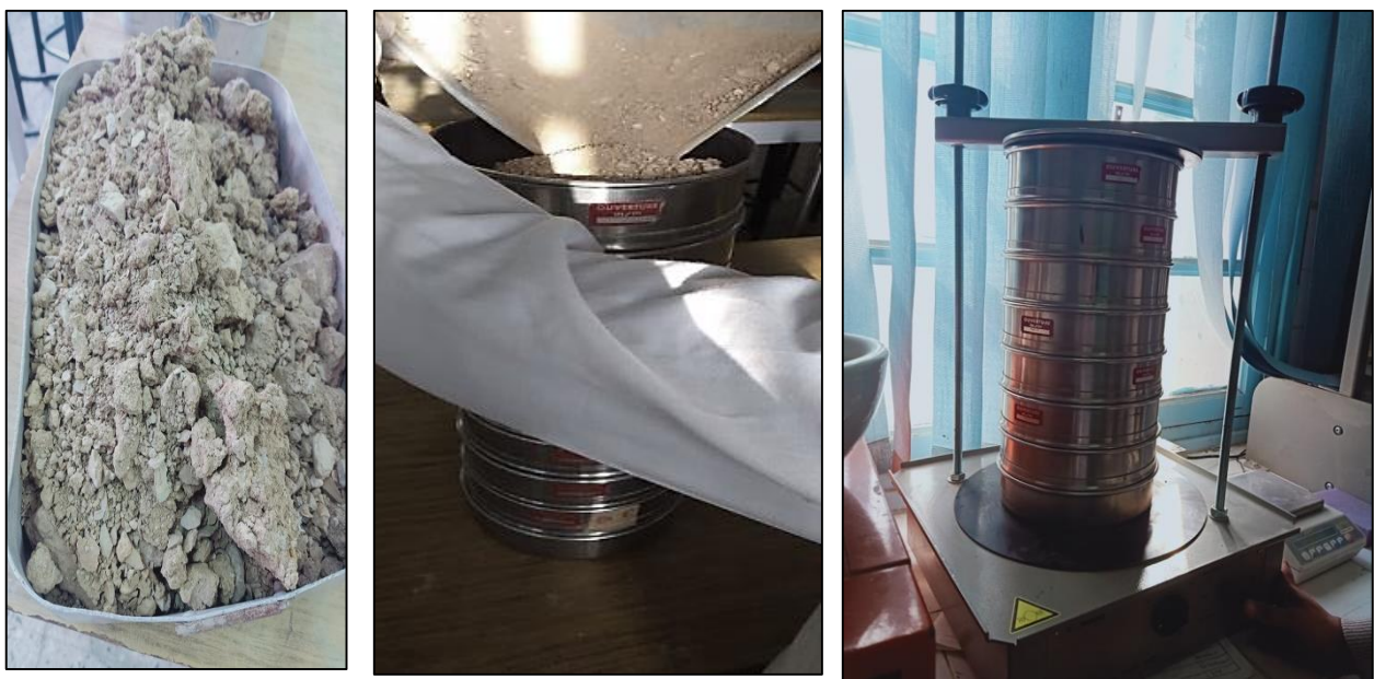
Figure 5.2 : manipulation d'essai granulométrie par tamisage
