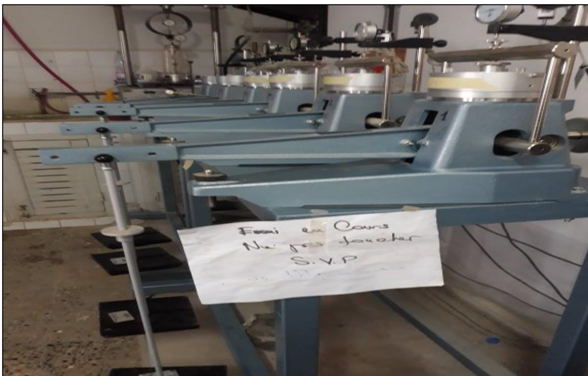
Figure 5.55 : Détail d'un œdomètre
