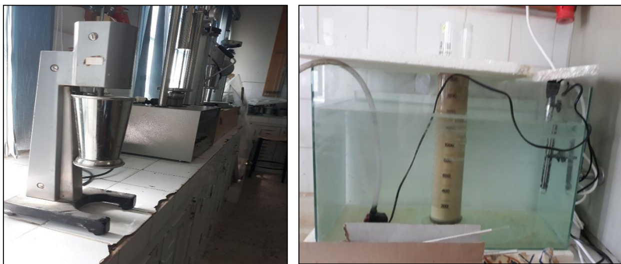
Figure 5.3 : manipulation d'essai granulométrique par sédimentométrie.
