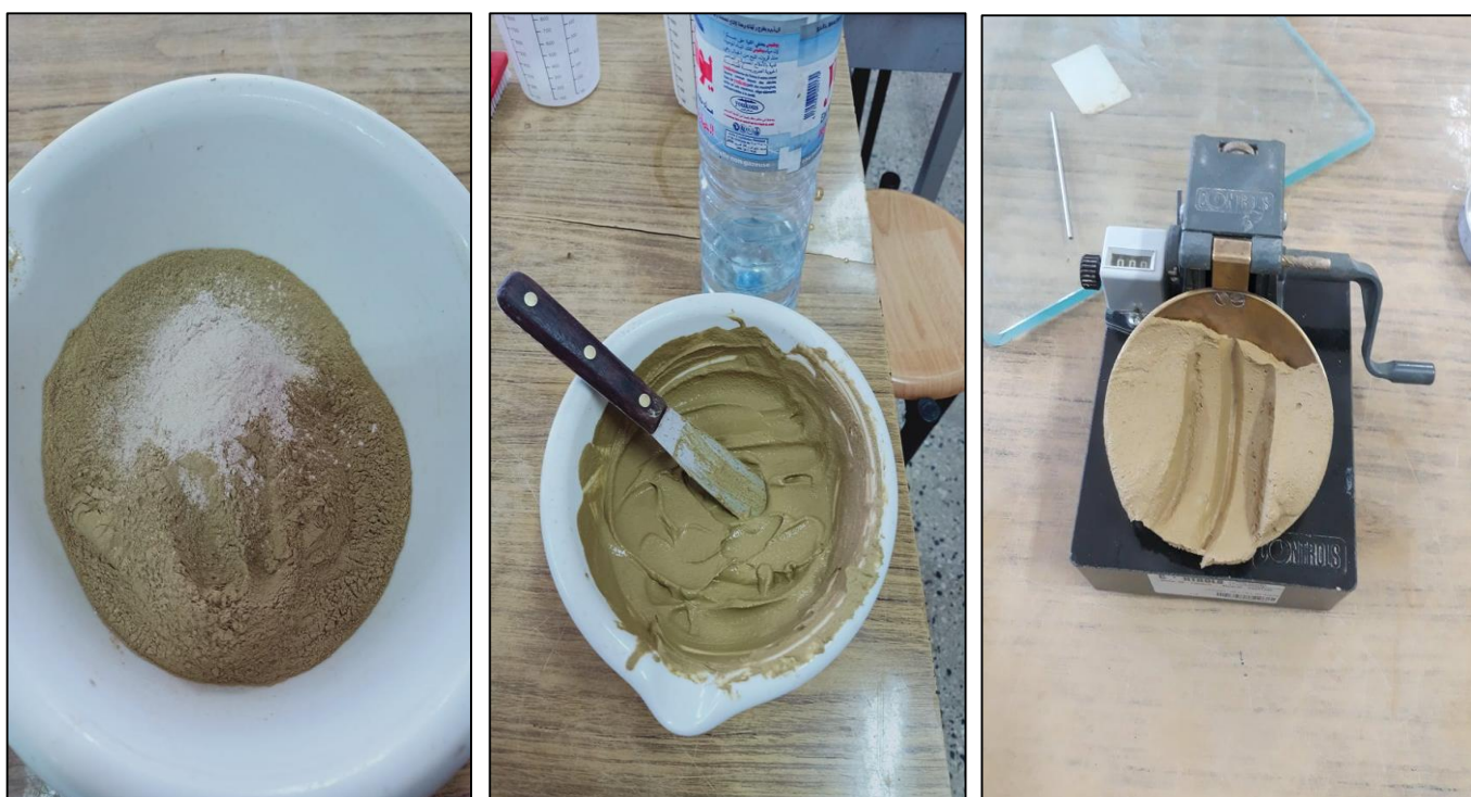
Figure 5.6 : appareil de Casagrande
