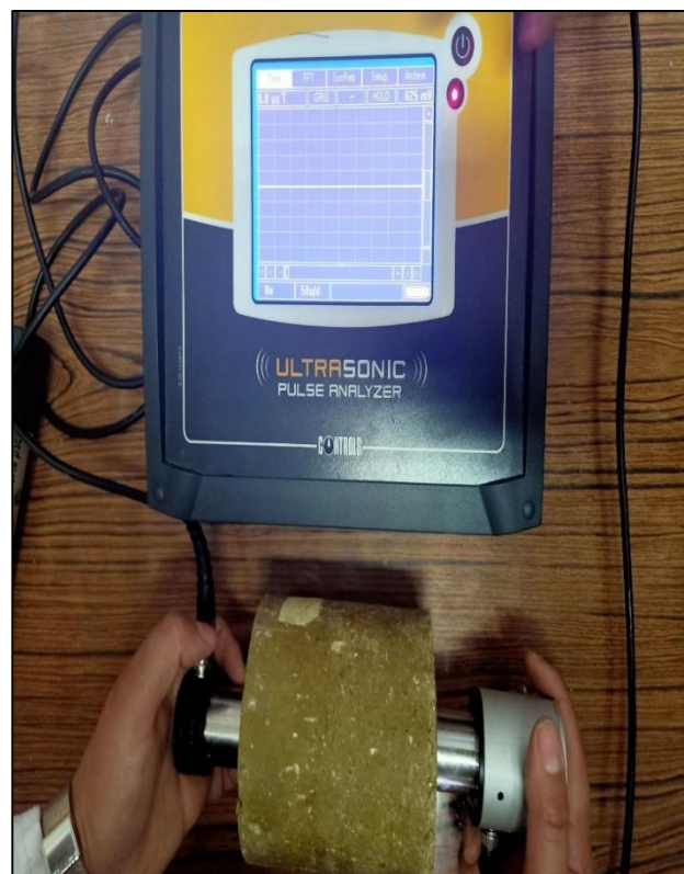
Figure 5.40 : Temps des ondes ultrasoniques sur des éprouvettes.
