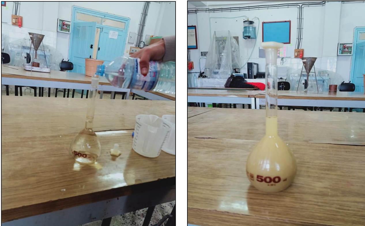
Figure : 5.15 : l’essai de poids spécifique par pycnomètre.
