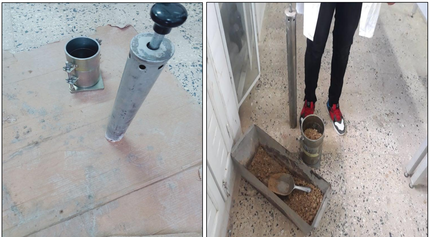
Figure 5.17 : essai Proctor modifié
