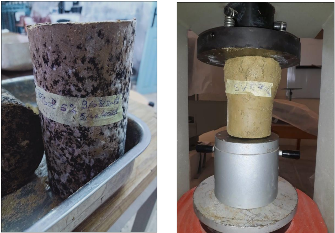
Figure 5.32 : La préparation des éprouvettes et rupture des échantillons sous un test de compression simple
