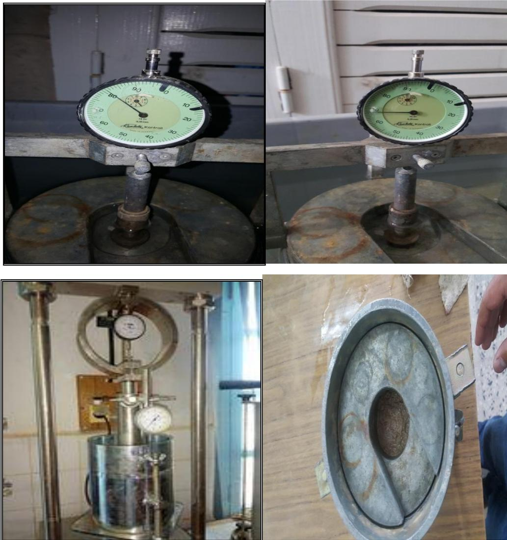
**Figure 5.32** -Manipulation d'essai CBR.
