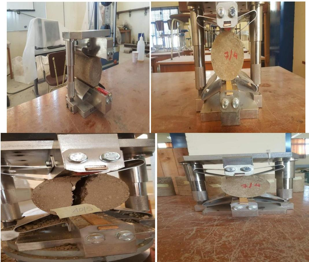
**Figure 6.15-**Illustration de l'essai de compression diamétrale.
