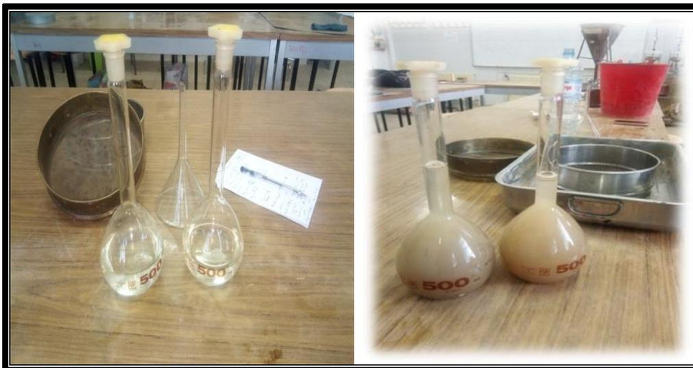
**Figure 5.21**-Manipulation d'essai densités spécifiques.
