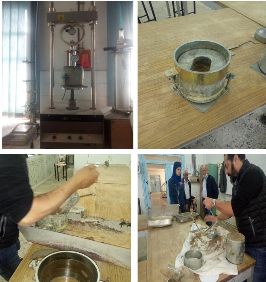
Figure 5.30-Réalisation de l'essai CBR.
