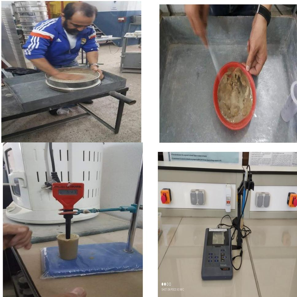
Figure 5.23-Mesure de l'acidité de sédiment de drague par un appareil de pH-mètre
