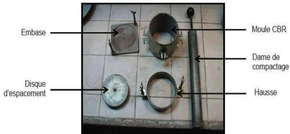
Figure 6.5-Matériel de l'essai Proctor Normale.
