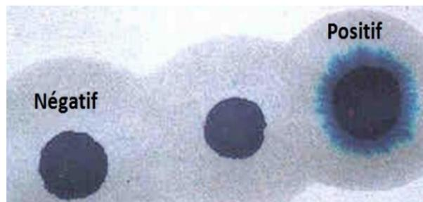
**Figure 5.18-**Tache référence d'essai bleu de méthylène.
