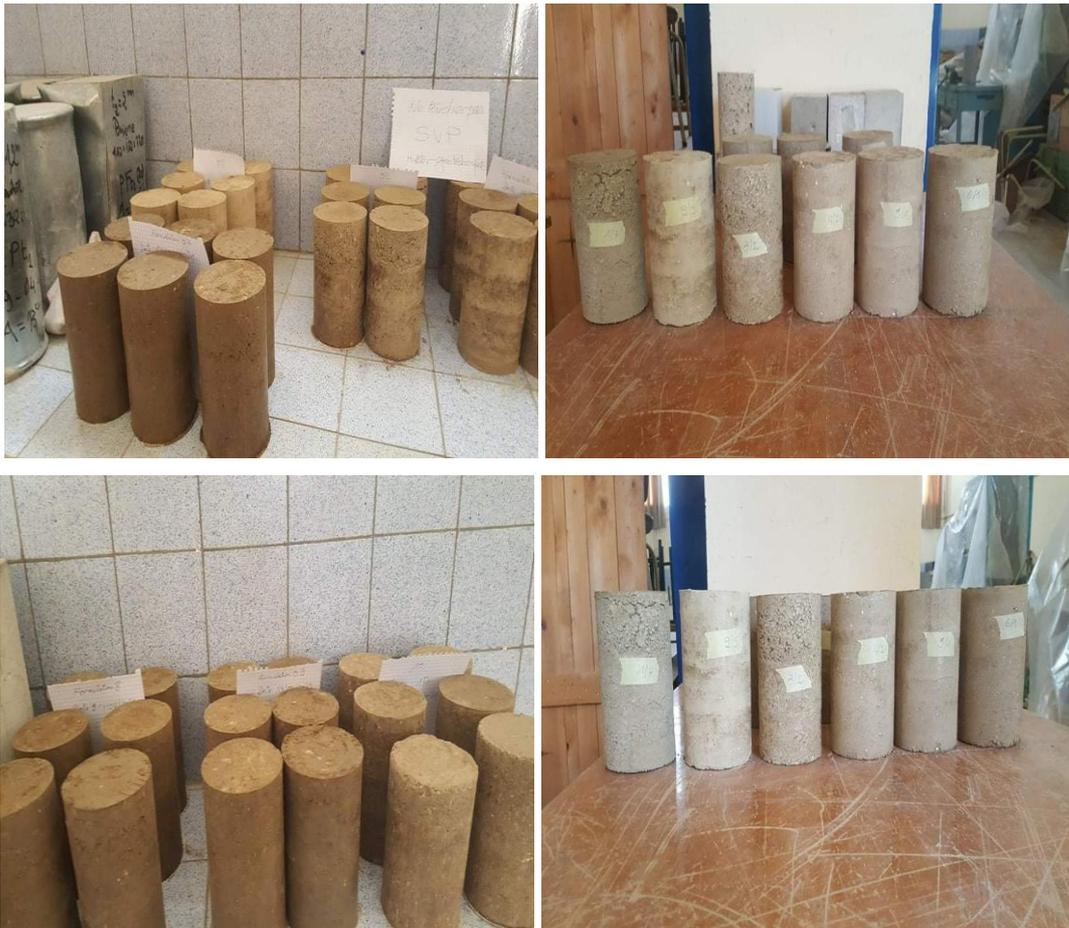
**Figure 6.12-** lustration des éprouvettes pour écrasement.
