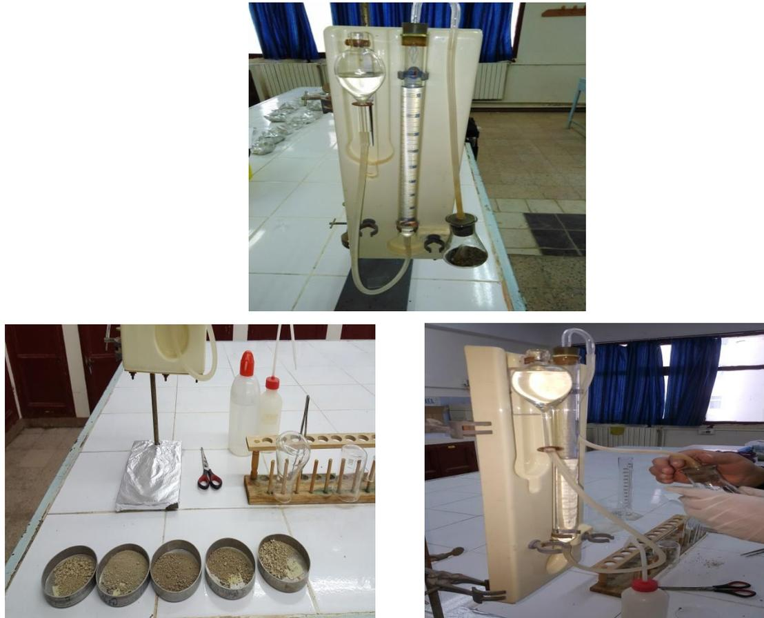
**Figure 5.22-**Manipulation de l'essai de calcimétrie.
