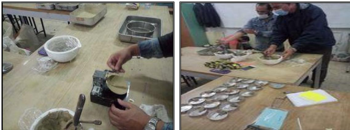
Figure 5.9-L'appareil de Casagrande
