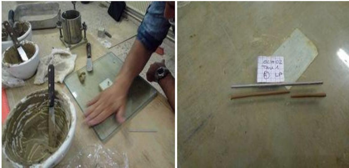
Figure 5.10-Détermination de la limite de plasticité WP.
