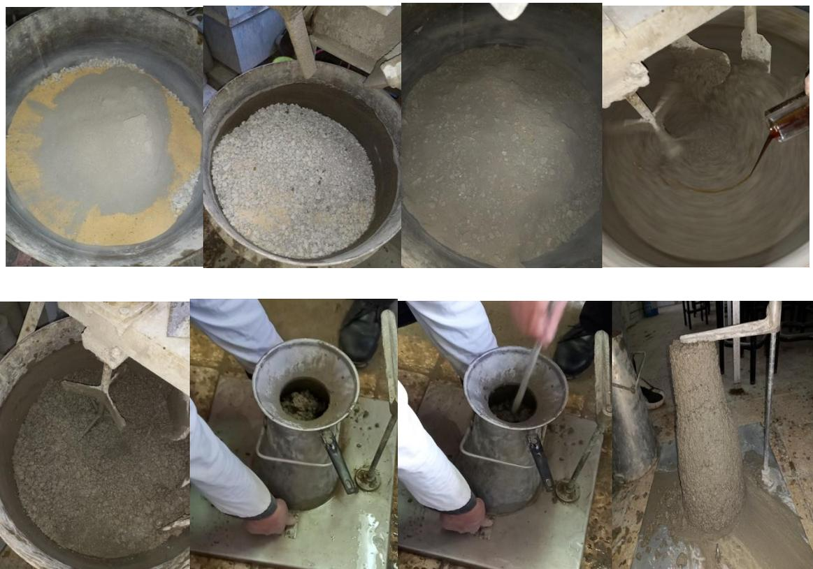
**Figure 3.8** : Mesure d'affaissement au cône d'Abrams.
