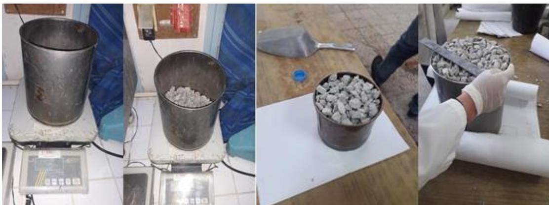
**Figure 3.4 :** Détermination de la masse volumique apparente.
