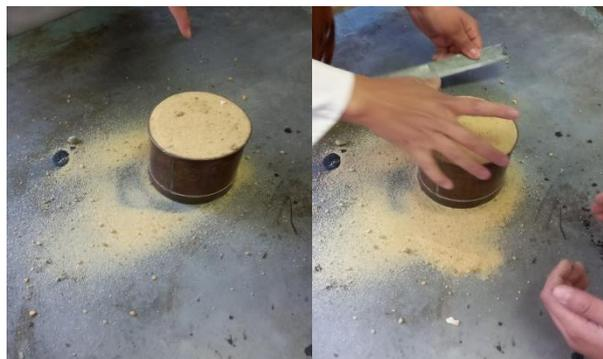
Figure 2.25 : le coulage de sable dans le moule au-dessus de la vibration
