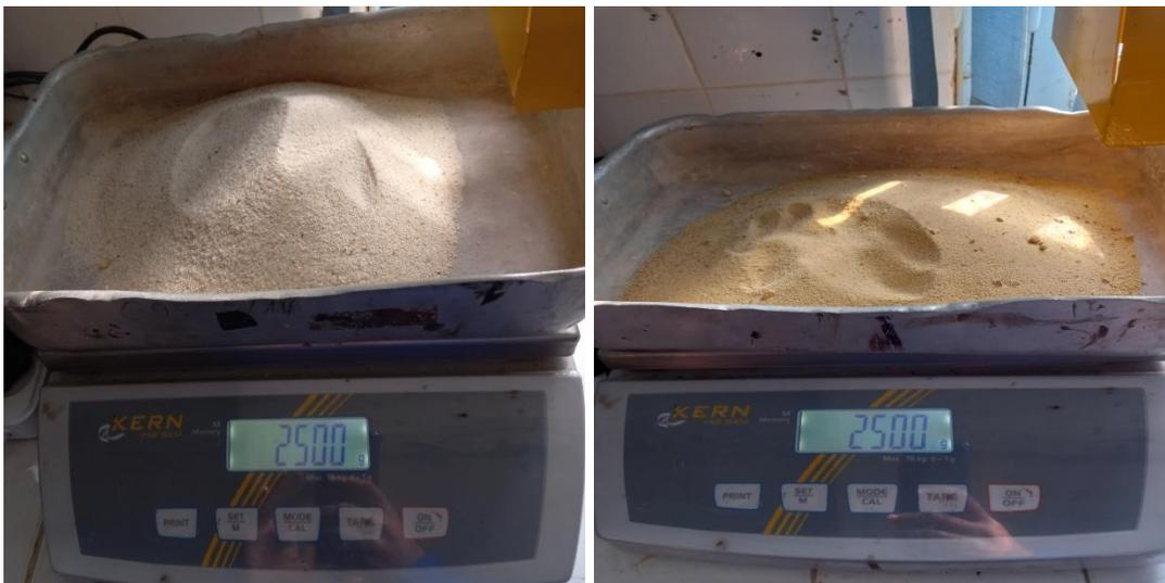
Figure 2.9 : La pesée de l'échantillon.
