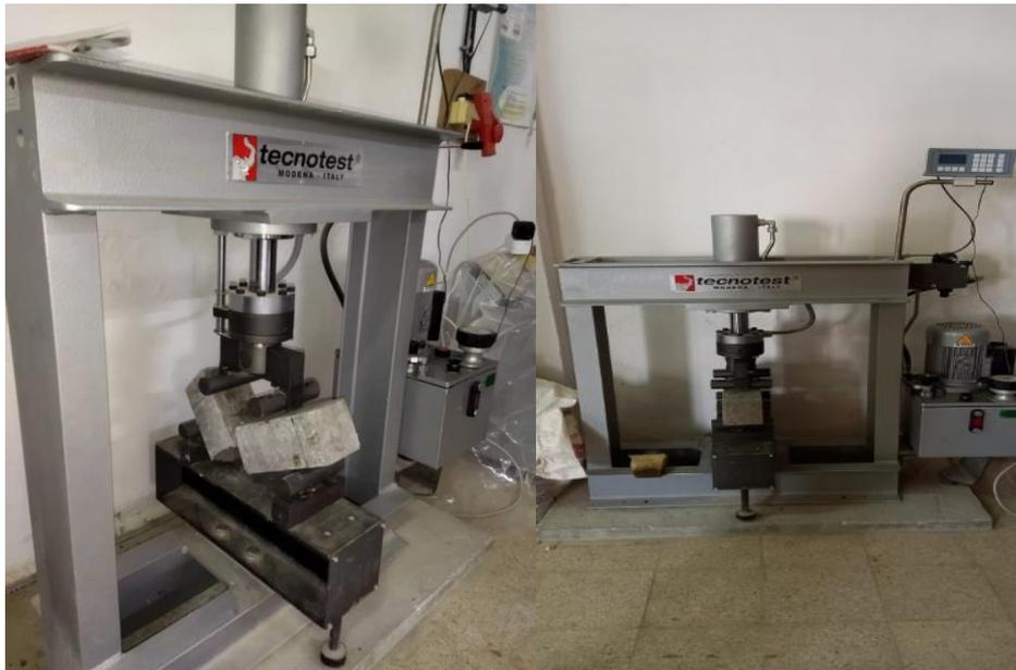
Figure 3.11 : Machine de flexion.
