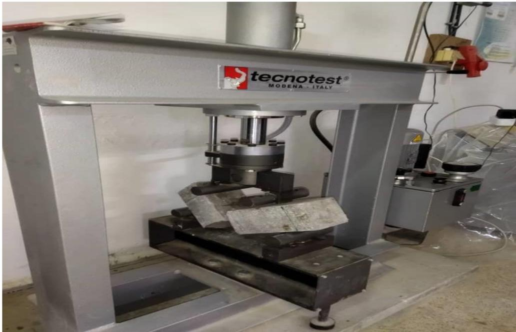
Figure 4.35 : Essai de la flexion simple
