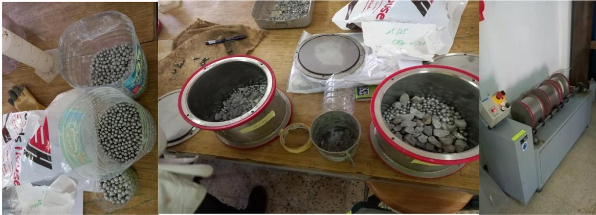
Figure 3.6 : Détermination de coefficient de Micro-Deval.
