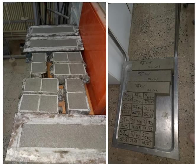
**Figure 3.10**: Eprouvettes cubiques et prismatiques
