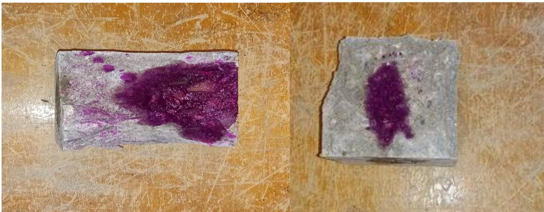
**Figure4.34** : L'essai de mesure Ph à l'aide de phénolphtaléine
