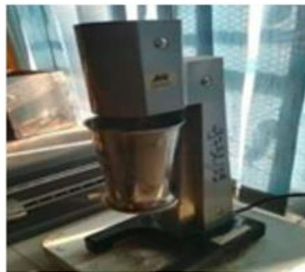
Figure 2.20 : L'agitation du sable avec l'eau.
