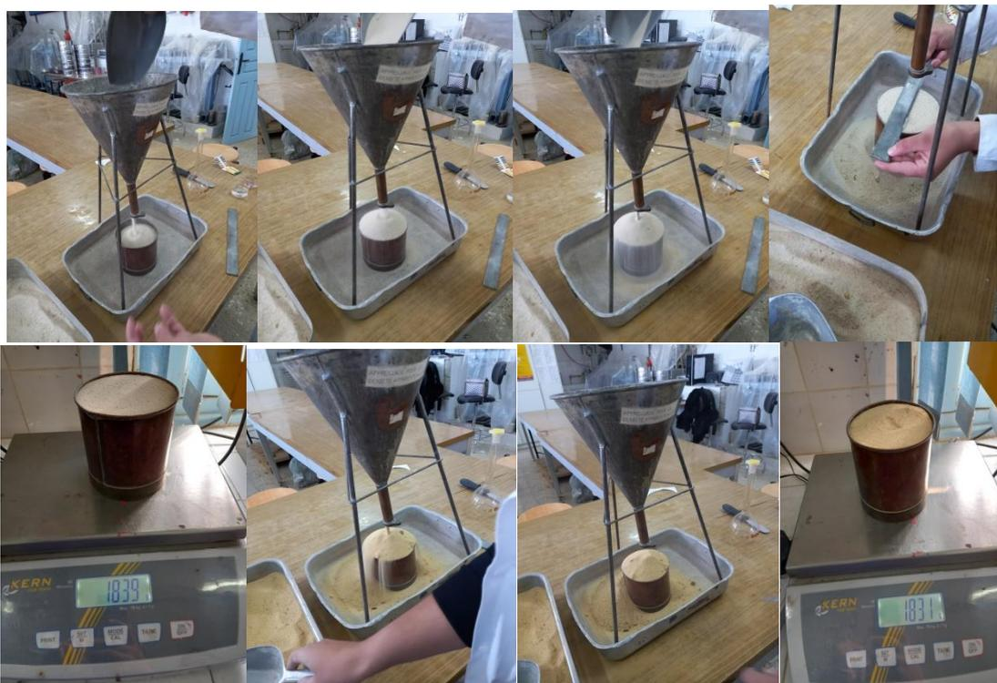
**Figure 2.13:** Détermination de la masse volumique apparent (sable blanc et sable jaune).
