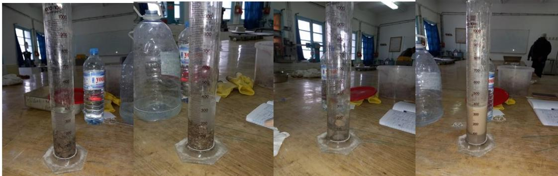
**Figure 3.5** : Détermination de la masse volumique absolue.
