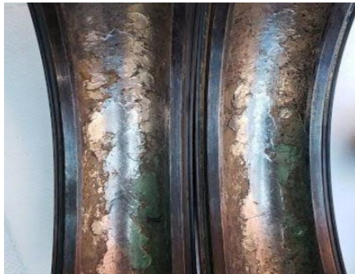
Figure (3.9): Ecaillage d'une piste de roulement
