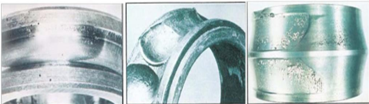
Figure (3.12): L'effet de la lubrification sur les roulements
