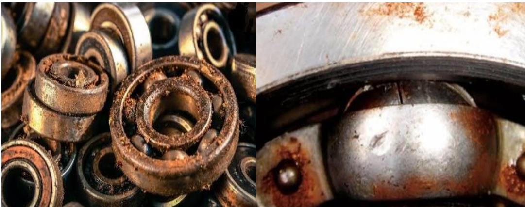
Figure (3.10): La corrosion du roulement
