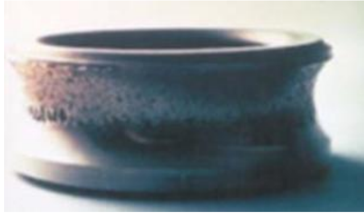
Figure (3.8) : Dégradations dues à des surcharges mécaniques
