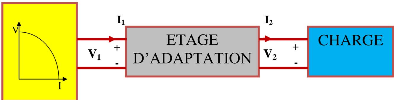
Fig I. 8. Etage d'adaptation entre le générateur PV et une charge.
