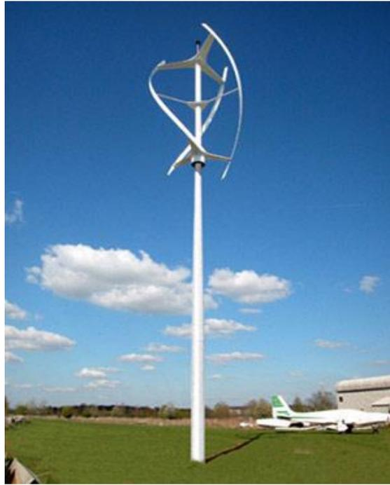
**Fig II. 7.** Aérogénérateur à axe vertical (structure de Darrieus)
