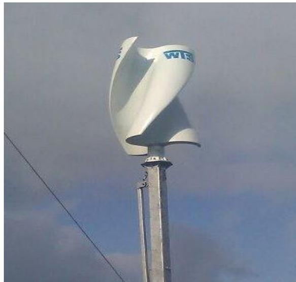
**Fig II .8.** Aérogénérateur à axe vertical (structure de Savonius)
