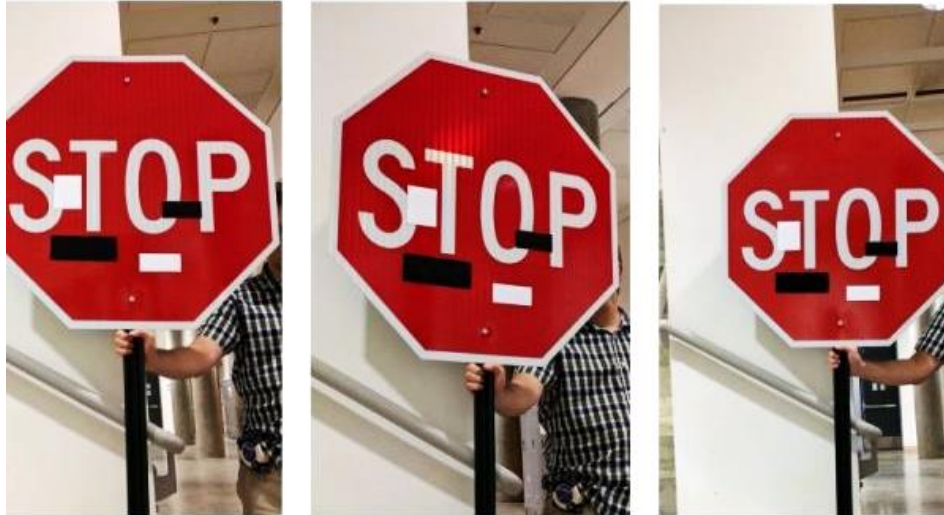
Figure 2. 4: Un simple autocollant pour tromper l'intelligence artificielle de la voiture autonome.
