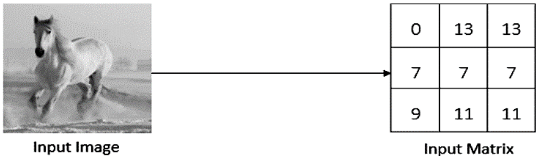
Figure1. 13: Image convertie en une matrice de valeurs de pixels.
