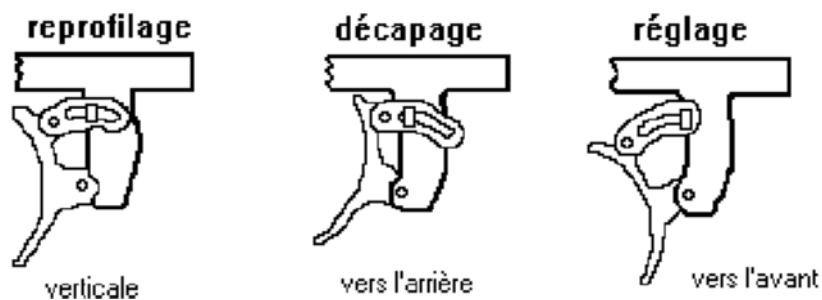
Figure 15 Inclinaison de la lame en fonction du type de travail.
