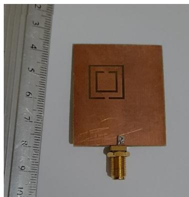
**Figure 3. 48.** Face inférieur de l'antenne
