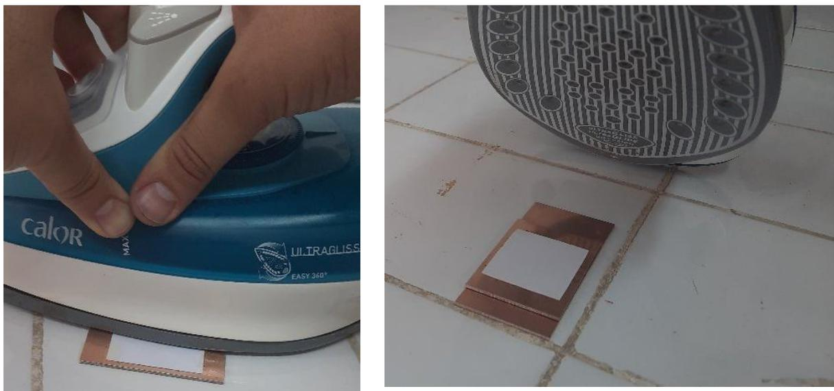
**Figure 3. 42.** Transfert du toner sur le cuivre avec le fer à repasser
