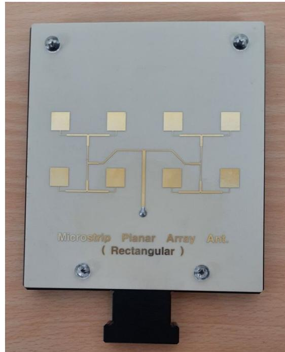
**Figure 1. 6 .** Antenne imprimée
