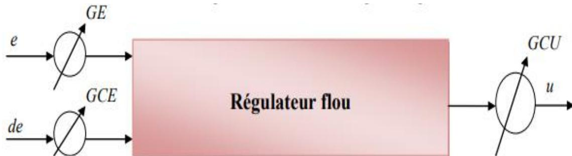
**Fig. III.2:** Configuration interne d'un régulateur par logique floue. [11]
