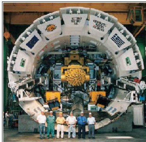
Figure.2.13. Tunnelier en mode ouvert utilisé pour percer un tunnel pour le métro d'Athènes [14]
