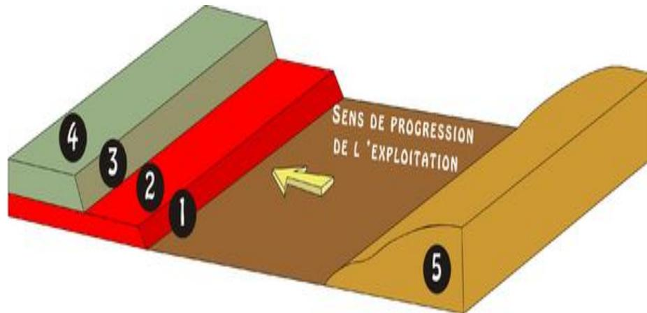
Fig. 24. Schéma de l'exploitation par découverte.
