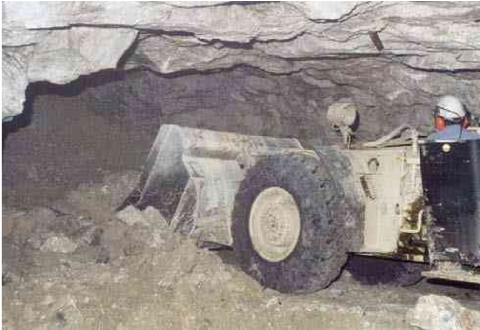
Fig. 14: Remblayage directe par le fond avec des engins mécaniques (Tritsch, 2007)
