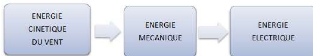
Figure 3.1 Conversion de l'énergie cinétique du vent.
