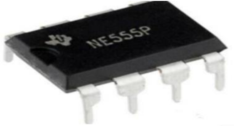
Figure 2.9 : Circuit intégré NE555
