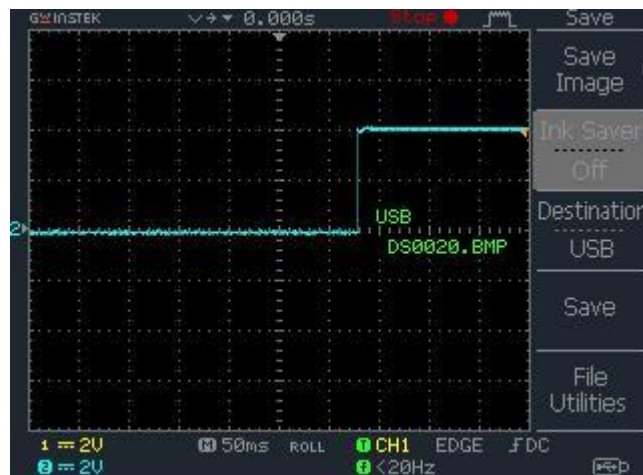
Figure 3.8: Signal de l’impulsion du circuit de capacité
