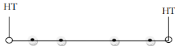
Figure 1.6 Exemple d'une structure d'un réseau radial.
