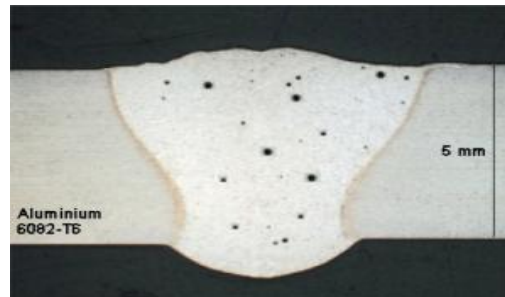
Figure 3.13 Exemple de soufflures
