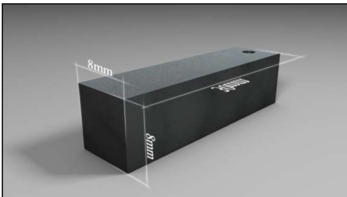
Figure III.1 : dimensions des échantillons utilisés lors de la nitruration.
