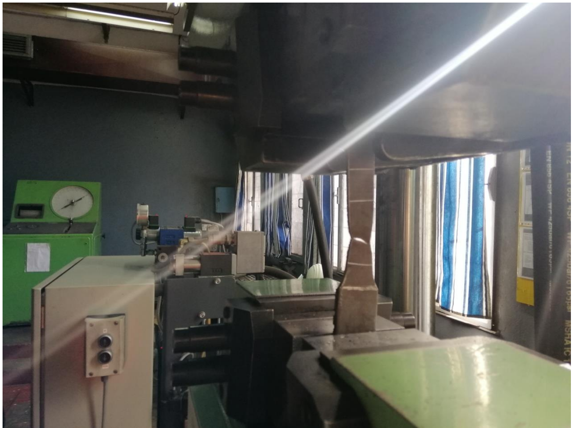
Figure III.10. Éprouvette pendant l'essai machine de traction.
