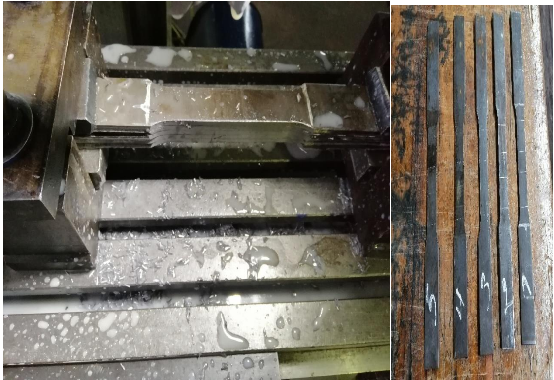
Figure III.9. Type d'éprouvette expérimentale de traction.
