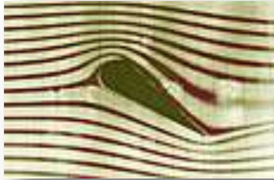
Fig.2.9.Expérience montrant un profil aérodynamique (aube).
