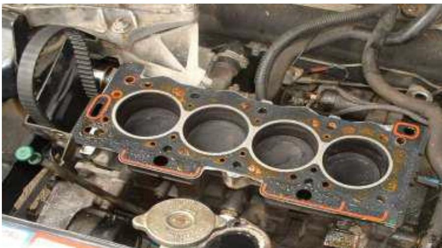
**Figure 1.5** Joint de culasse
