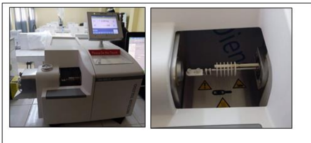
Figure II.5 : Montage de la machine TGA/DSC 3+ avec leur balance.
