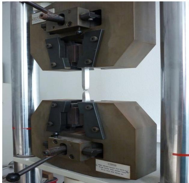
**Figure III.3** : Essai de traction [57].
