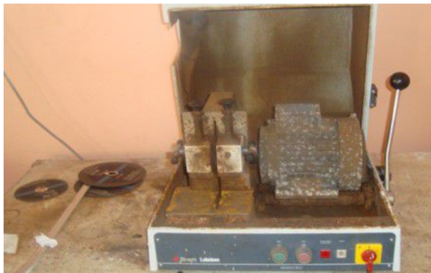
Figure 3.2 : Tronçonneuse à eaux.
