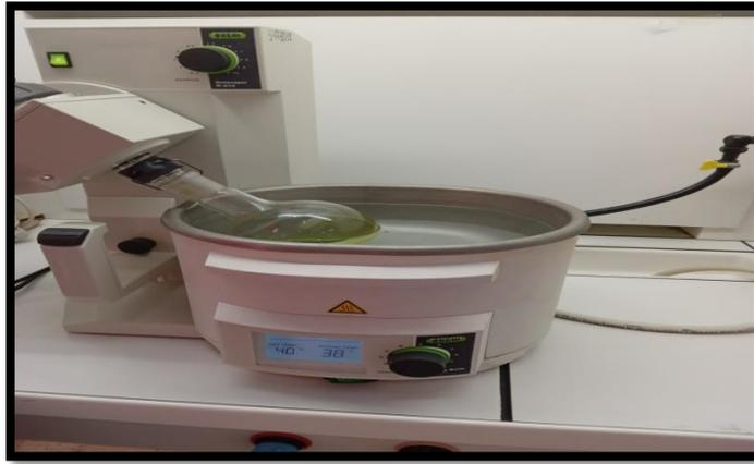
Figure 12. Evaporateur (Rota-vap) rotatif .(Photo personnel ,2022).
