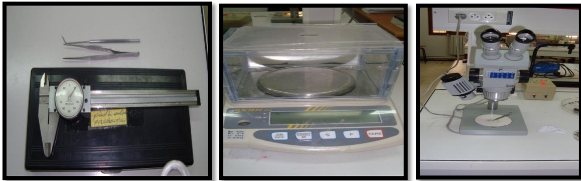
a- Pied à coulisse, aiguille et Pince b- Balance de précision c- Loupe binoculaire
