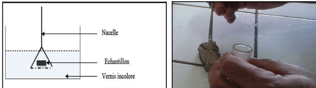
Figure IV.3 L'imprégnation des échantillons au vernis incolore.
