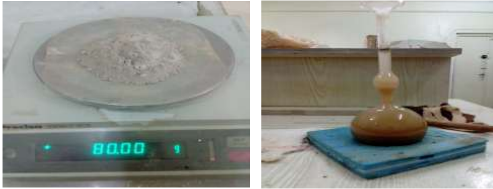
Photo IV.14 Mesure de la densité par la méthode de LECHATELIER
