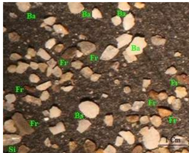
Photo V.9 Tranche granulométrique [-0.5 +0.250 mm] montrant des grains de barytine associés au quartz et à d'autres fragments rocheux. (X10). (Ba) : barytine, (Si) : silice = quartz, (Fr) : fragment rocheux.
