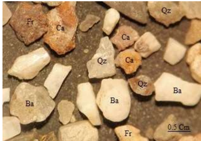
Photo V.8 Tranche granulométrique [-1+0.5 mm] montrant des grains minéraux de barytine associés au quartz, à la calcite et à d'autres fragments rocheux. (X10). (Ba) : barytine, (Qz) : quartz, (Ca) : calcite, (Fr) : fragment rocheux.
