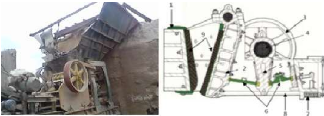
Photo III.6 Un concasseur à mâchoires à mouvement simple (ENOF 2018)
