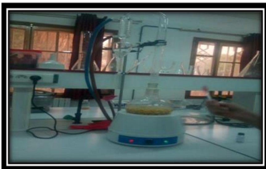
Figure 16 : Montage d'hydrodistillateur type Clevenger(photo personnelle).
