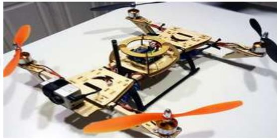
Figure 1.4. Châssis en H
