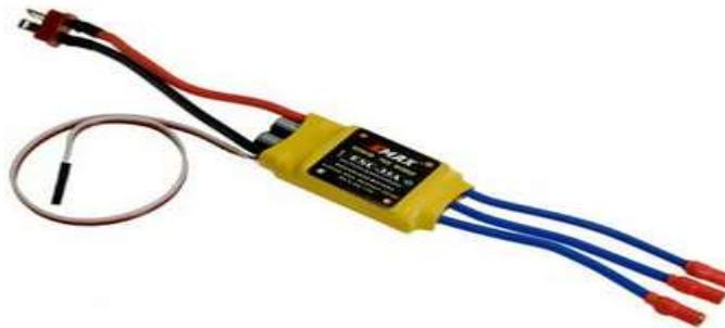
Figure 1.6. Contrôleur ESC (Electronic Speed Control)
