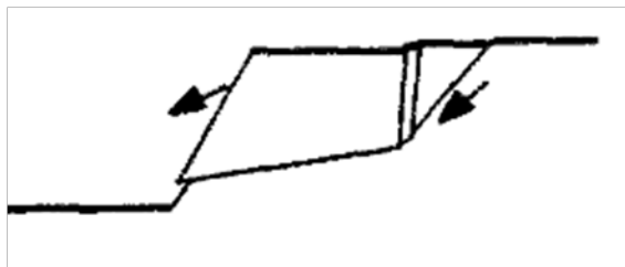
Figure 1.21 : Rupture bilinéaire (type Cox-Cytovitch).[18]
