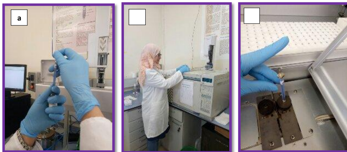
Figure 13. Chromatographie en phase gazeuse couplée à la spectrométrie de masse (CPG-SM) (a :prélèvement de l'HE ; b : préparation de l'injection ; c : injection de l'HE) (photo personnelle, 2019).
