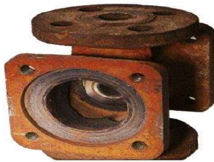
Figure I.2. Corrosion générale (rouille) d'une pièce en acier.
