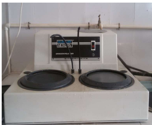
Figure. I.6 : Appareil de polissage (Grinder-Polishe)
