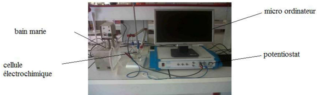
Figure. I.4 : Dispositif de mesures électrochimiques
