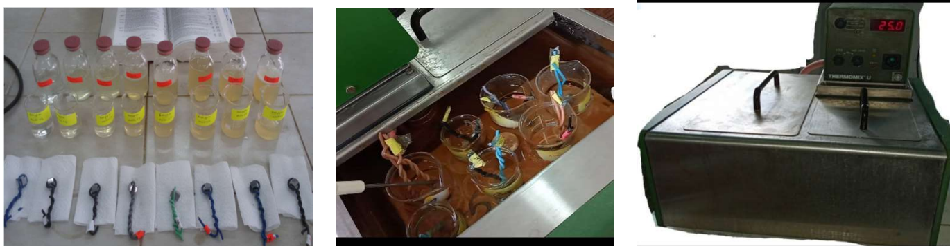
Figure. I.1 : Appareillage et préparation des solutions (méthode gravimétrique).
