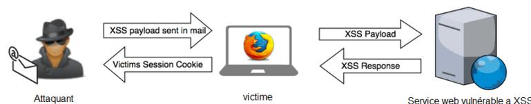
FIGURE 1.2 – Fonctionnement de l'attaque XSS[50].
