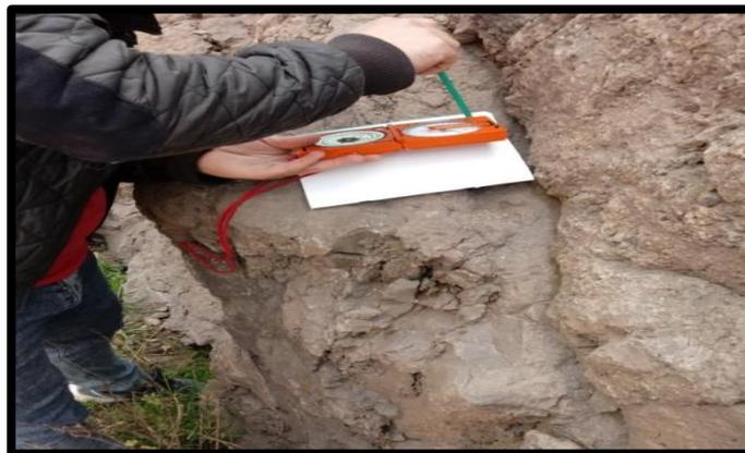
**Figure 5.18** : Levé d'un plan d'une discontinuité (Calcaire)
