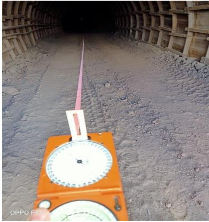
**Figure 5.13 :** Exemple de mesure d'orientation des axes
