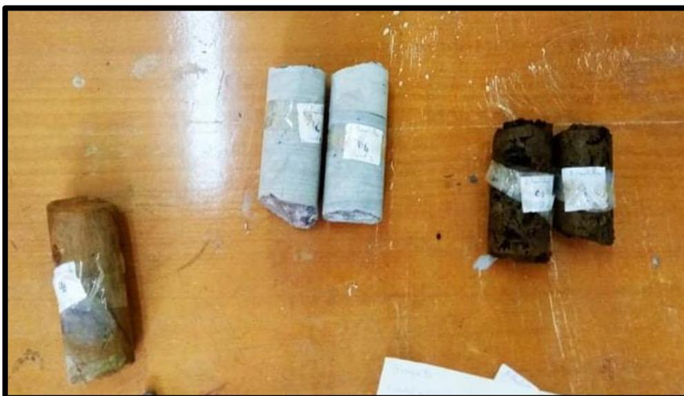
**Figure 5.16 :** Exemple d'échantillons carottés
