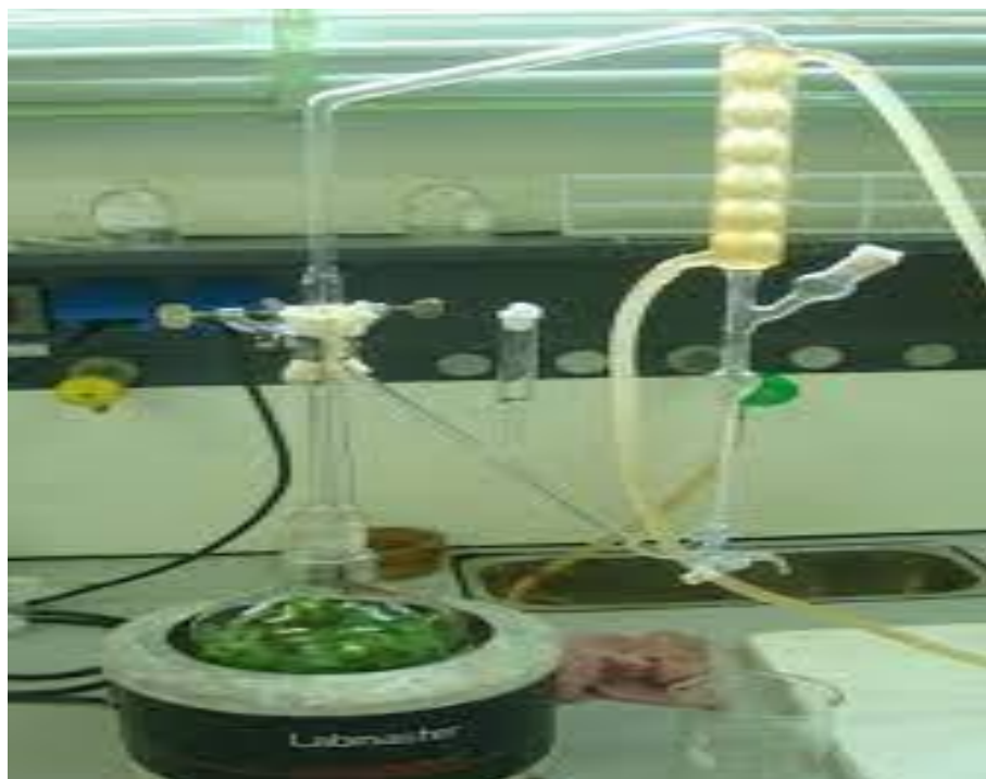
Figure N°9 : Description schématique du système d'extraction par hydrodistillation
