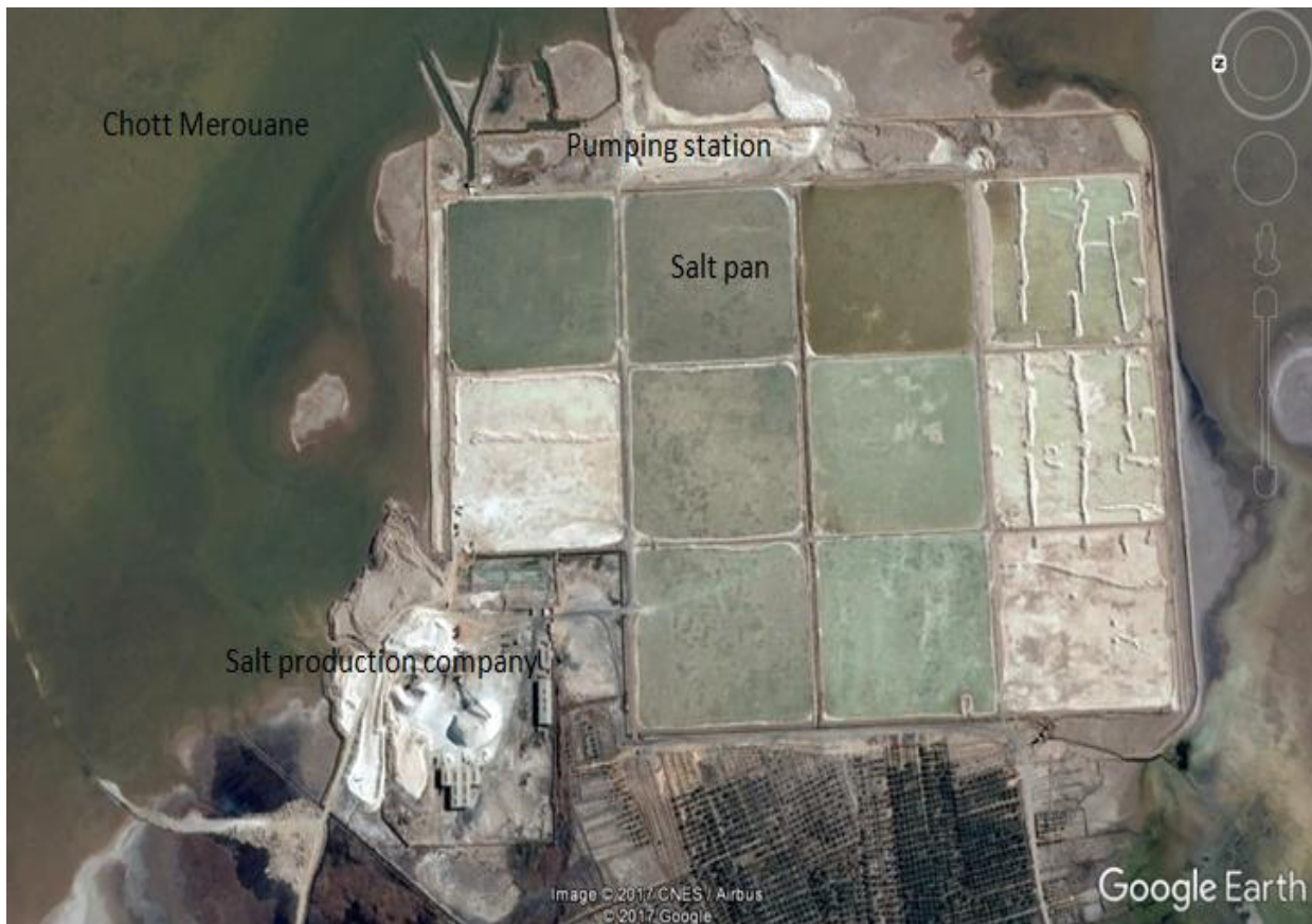
Figure 45 – Unité des Salins Merouane El Meghaier (SME), utilisation des tables salantes.
