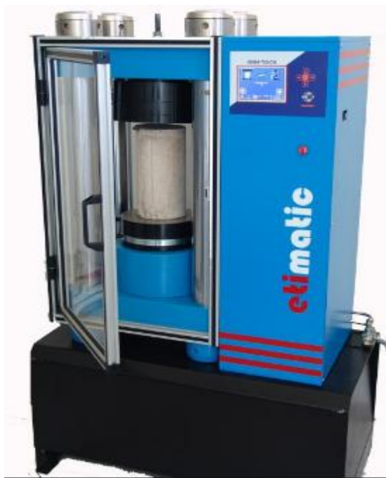
Figure 47- Photographie d'appareil de résistance à la compression uniaxiale des roches.
