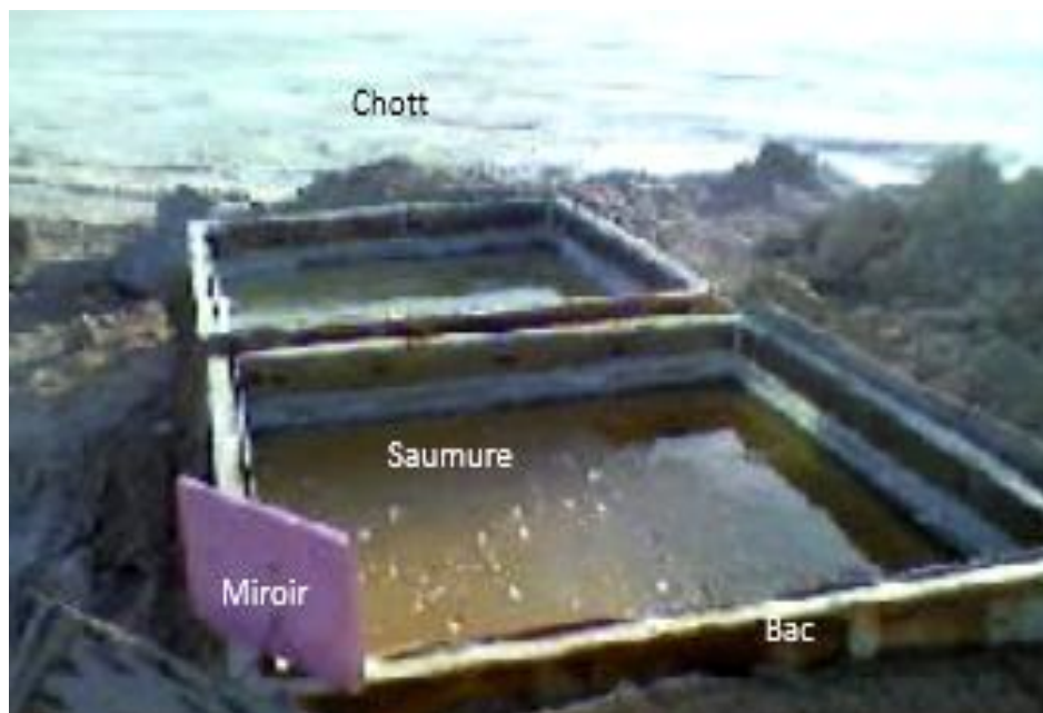
Figure 50- photographie des bacs d'expérimentation de la saumure du Chott Merouane - El Oued, mai et juin 2015 (Remli S., et Bounouala M., 2018)
