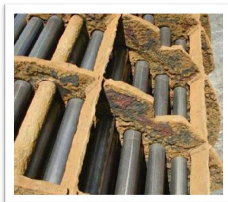
*Figure – I.6 : Corrosion galvanique des chicanes en acier de l'échangeur
