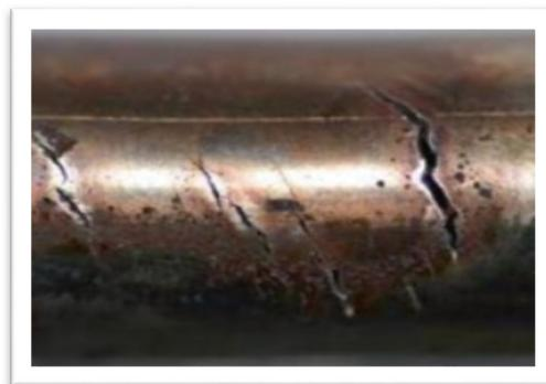
*Figure – I.8 : CSC d'un tube en acier inoxydable [13]*
