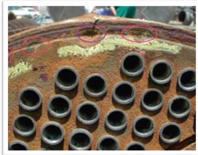
*Figure – I.5 : Corrosion par crevasse entre plaque tubulaire et tubes d'échangeur*
