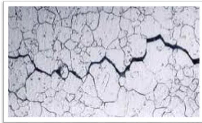
*Figure – I.4 : Structure métallurgique touchée par la corrosion inter-granulaire*
