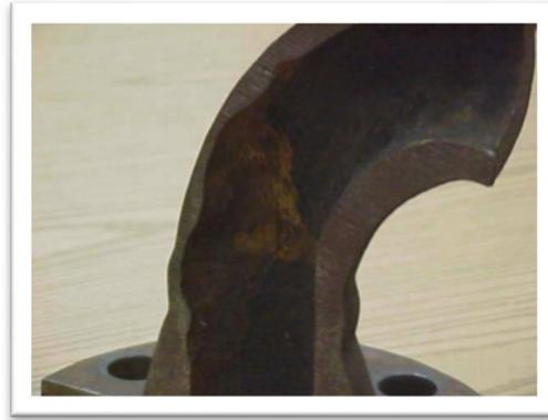
*Figure – I.7 : Corrosion par érosion*
