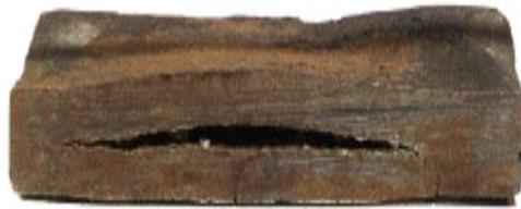
**Figure I.14 :** Des cloques proviennent de la diffusion d'atomes d'hydrogène formés pendant le processus de corrosion par les sulfures à la surface du matériau.
