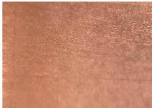
Acier au carbone immergé dans une solution de HCl 1 M contenant 800 ppm d'EBCA
