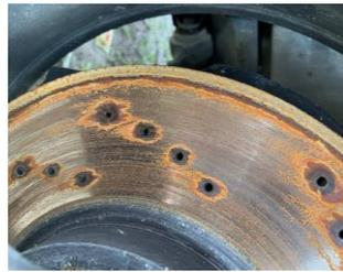
Figure I.9 : Corrosion par frottement d'un frein de disque.
