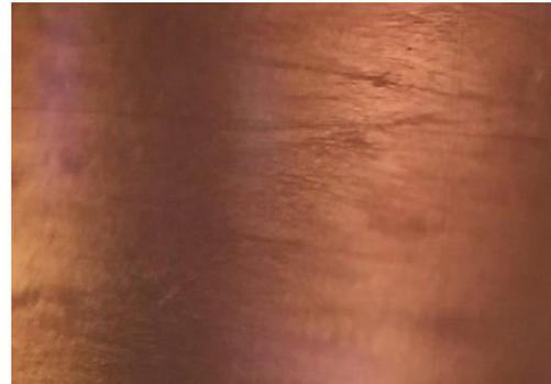
Acier au carbone immergé dans du HCl 1 M contenant 1000 ppm d'EACA
