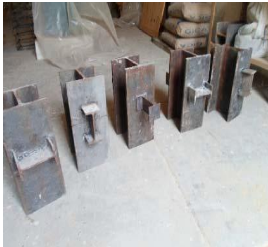
Figure 1. 10 échantillons push-out testés.
