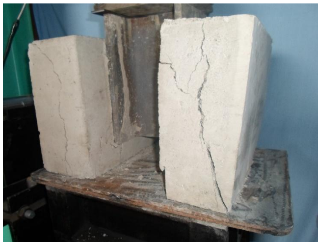
Figure 3. 8 Fissuration et éclatement du béton
