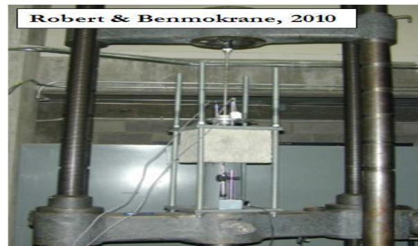
Figure 1. 6 Principe de l'essai Pull out et exemple de montage
