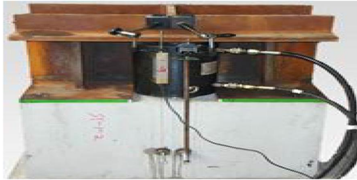
Figure 1. 12 Mise en place de tests d'arrachement. [17]
