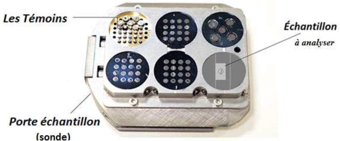
Figure II.15 Porte échantillon contenant les principaux étalons (*Témoins*), de référence et les échantillons à analyser par microsonde. [23]
