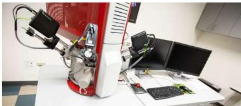
**Figure I.10** La sonde avec les deux spectromètres EDS et WDS. [10]
