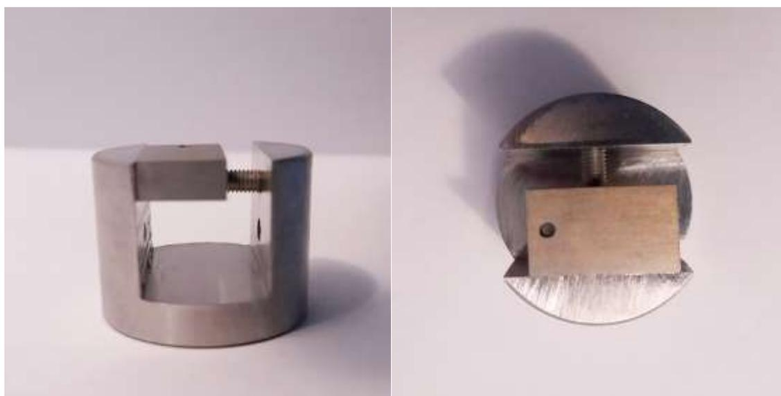
**Figure II.12** Échantillon dans un support cylindrique prêts pour l'analyse par microsonde.
