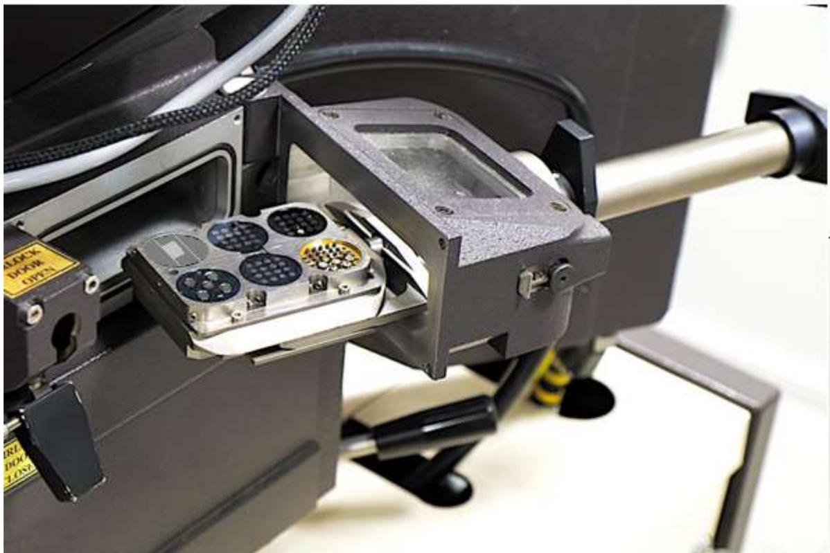
Figure II.16 Mécanisme d'enfournement des échantillons. [23]
