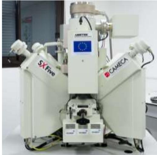
**Figure I.18** Microsonde de Castaing CAMECA SX Five nouvelle génération. [13]
