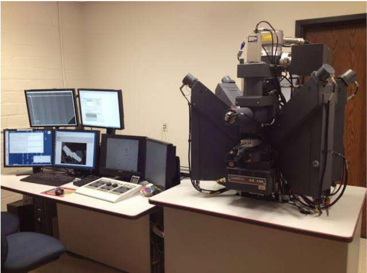
**Figure I.3** Photographie de la microsonde électronique CAMECA SX 100 du SRMP du CEA de Saclay. [4]
