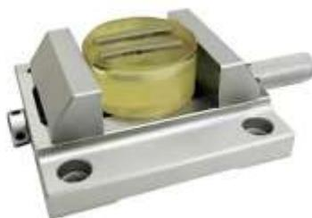
**Figure II.8** Etau pour casser la résine des échantillons. [24]
