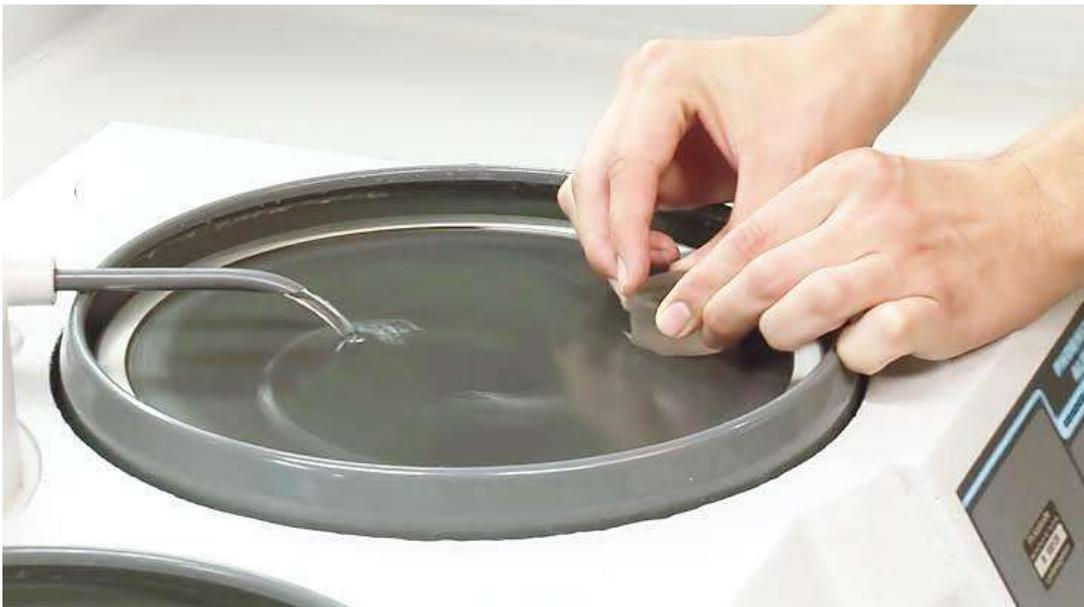
**Figure II.5** Refroidissement par eau. [19]
