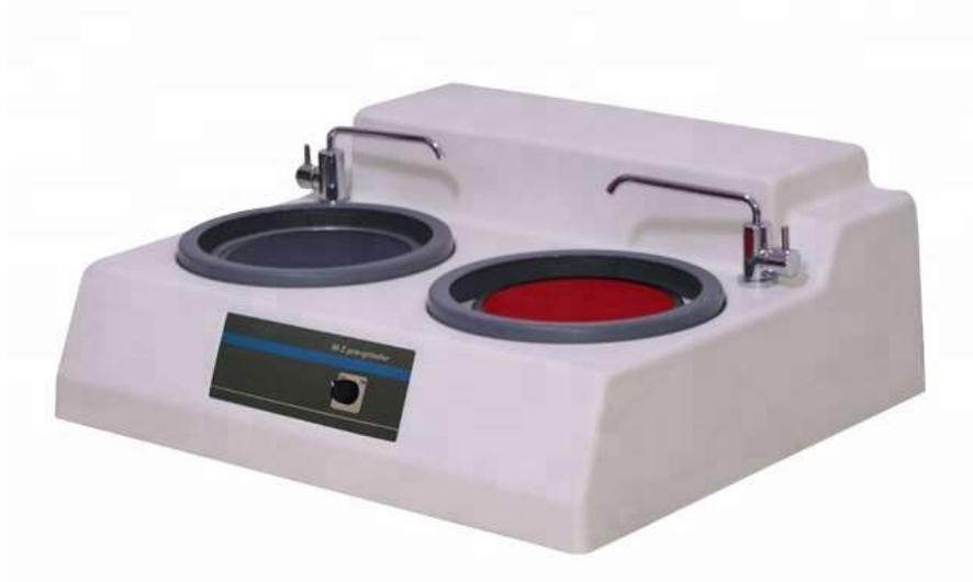
**Figure II.4** Polisseuse mécanique manuelle à disques ( $f$  200 à 300 mm - 100 à 300 tr/mn). [19]
