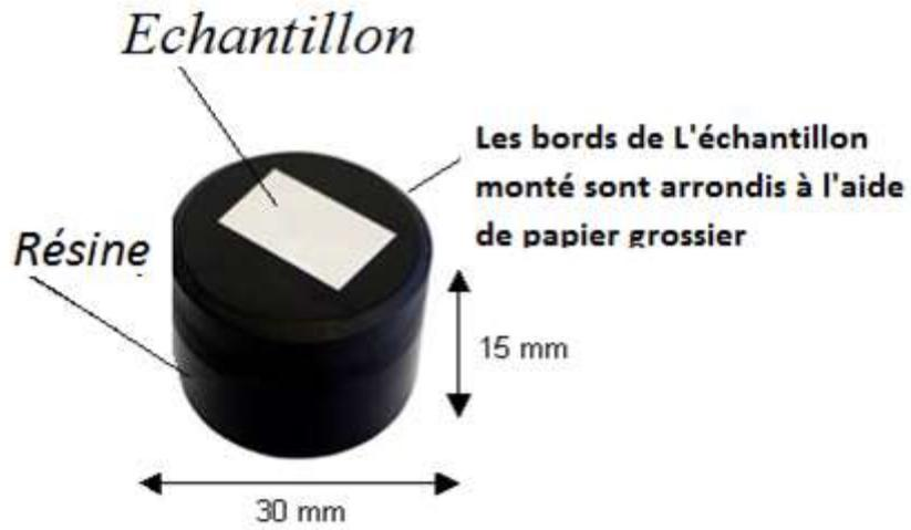
Figure II.6 Échantillon adaptée à la taille du cylindre. [24]
