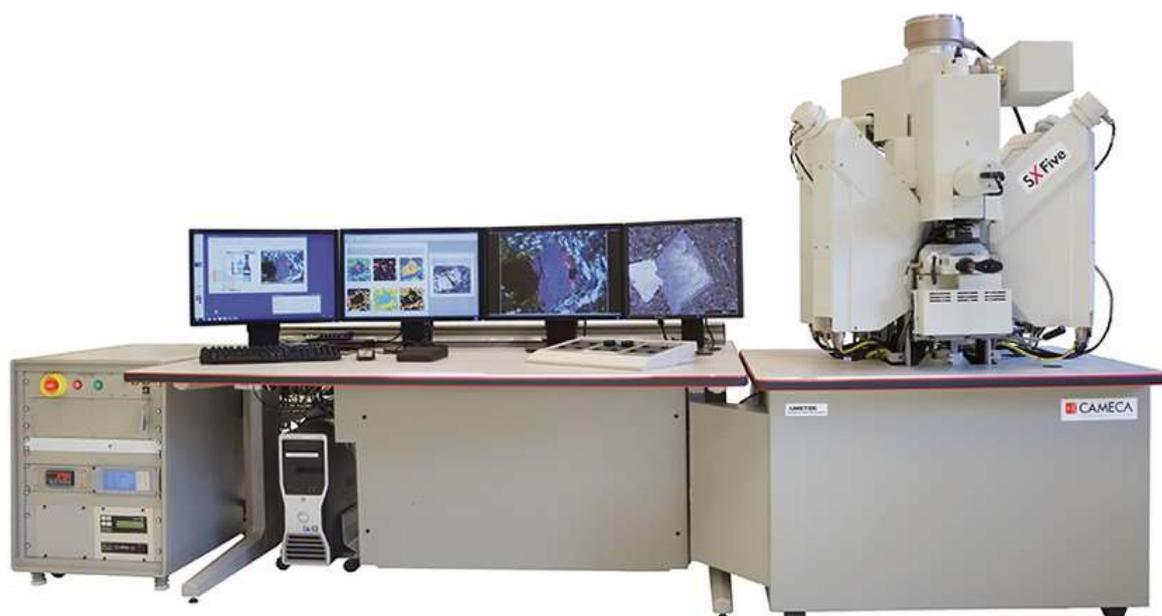
**Figure 1:** Microsonde de **castaing**-Caméca **SXFive** EPMA.
