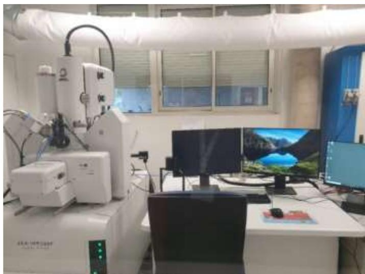
**Figure I.20** Microsonde électronique IHP 200F JEOL. [15]
