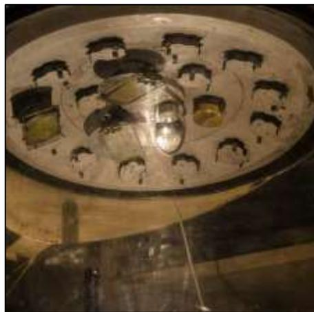
**Figure A.9.** Système d'évaporation du carbone à grande chambre (revêtement Edwards entièrement remis à neuf).
