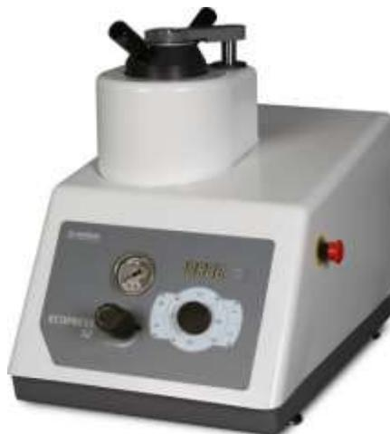
**Figure II.1** Enrobeuse à chaud. [18]
