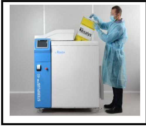
صور ( 54 ، 55 ) نموذج لجهاز المعالجة البخارية للنفايات الاستشفائية
