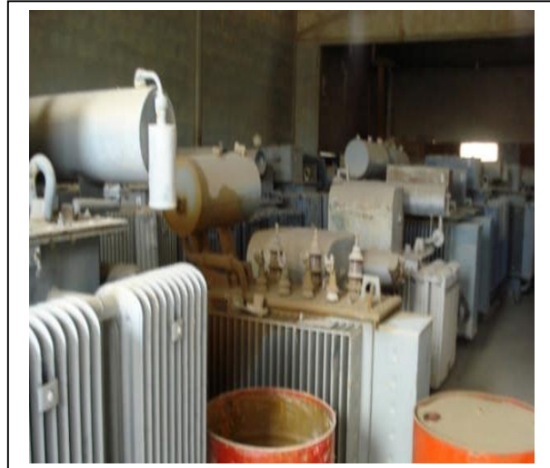
صورة ( 23 ) محول كهربائي يحتوي على زيوت الاسكارال ، بتاريخ 22 فيفري 2018
