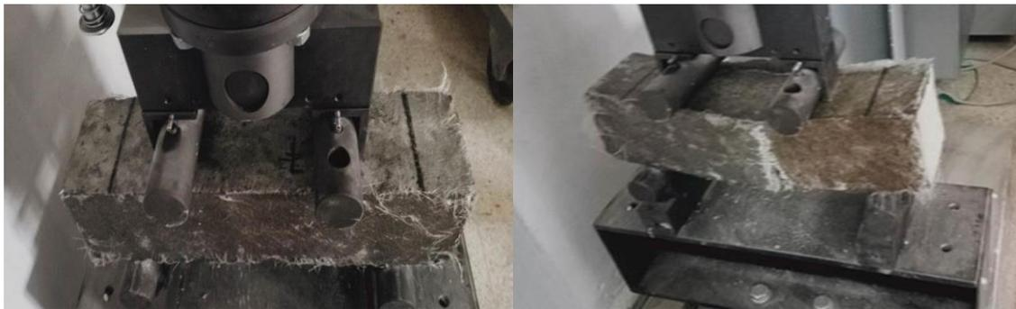
a- L'éprouvette protégée avant l'écrasement.
