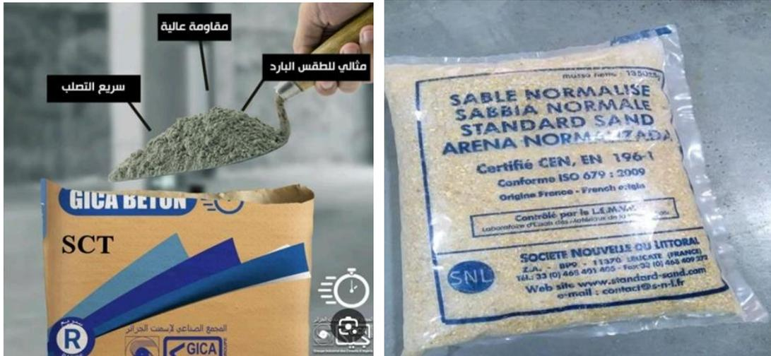
Figure II.1 : Sac de ciment avec du sable normalisé.
