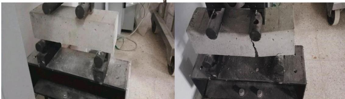
c- L'éprouvette brute avant l'écrasement.
