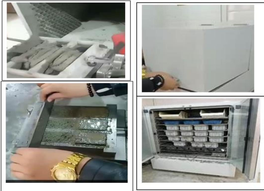
**Figure II.2 :** Etapes nécessaires suivie pour la préparation des échantillons.
