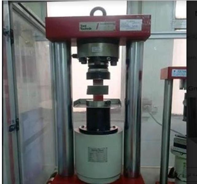
**Figure II.13 :** Essai de compression sur mortier.
