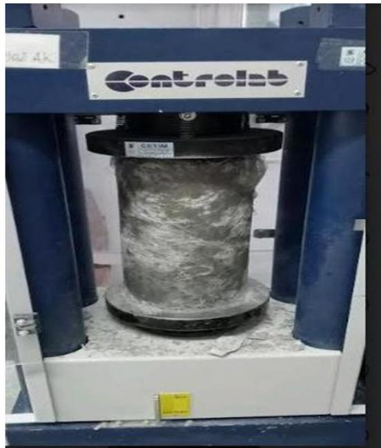
**Figure II.16** : Essai de compression sur béton cylindrique.
