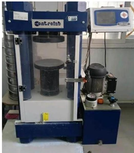
**Figure II.14 :** Appareil CONTROLAB de compression de béton.
