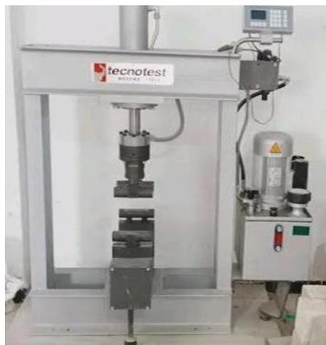
**Figure II.9** : appareil -Tecno test- de l'essai de flexion 4 point.
