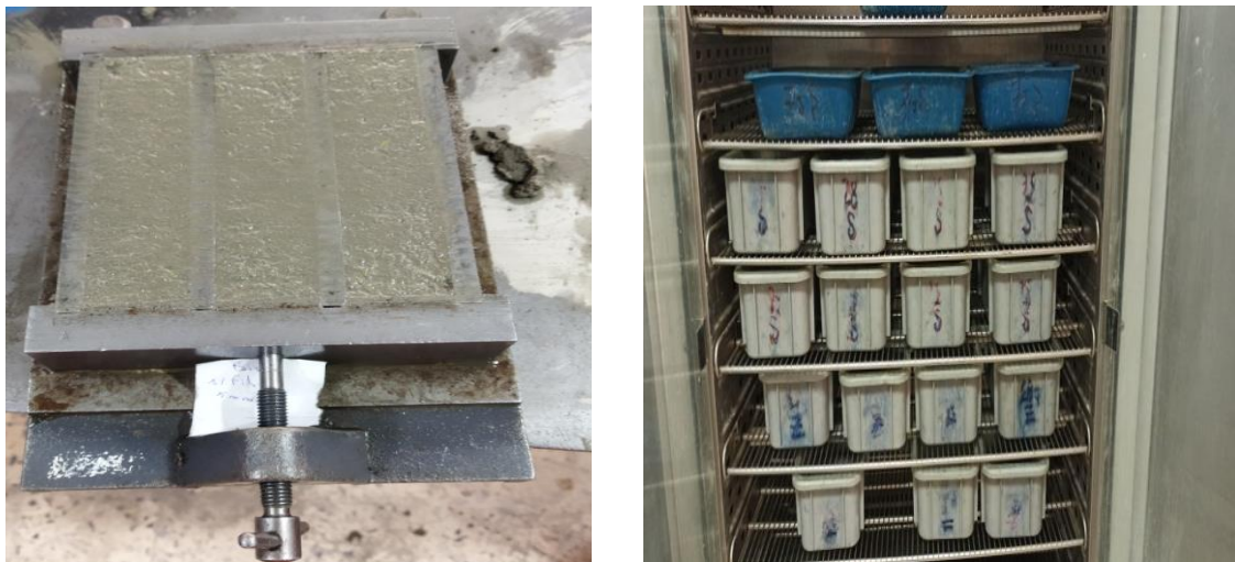
Figure II.9: Les échantillons aplatis et conservés dans une armoire humide.
