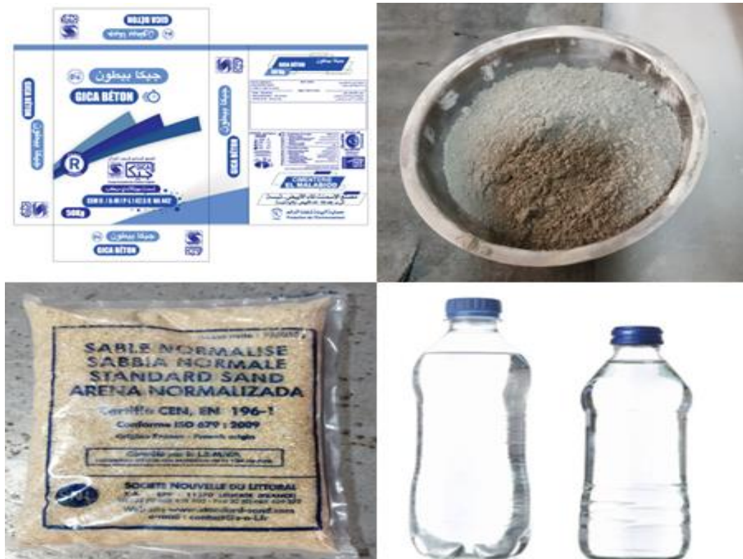
Figure II.5: Différents composants du mortier.
