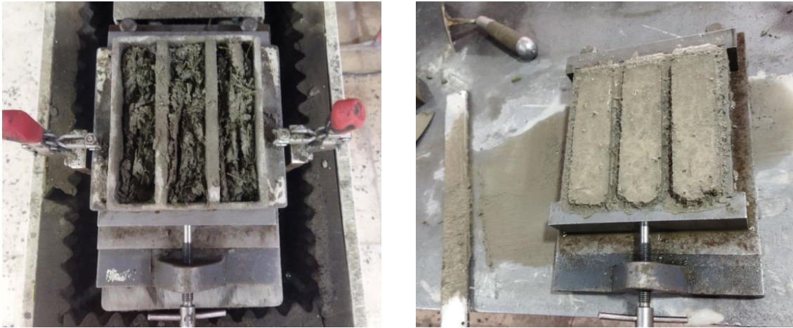
Figure II.8: Exposition des échantillon à des chocs.
