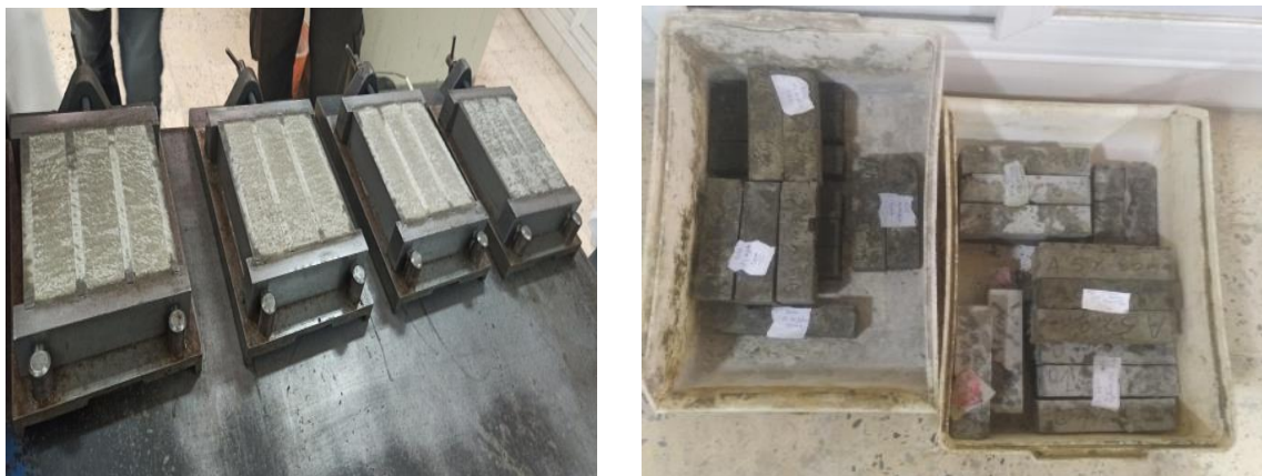
Figure II.10: Démoulage des éprouvettes puis les numérotés.
