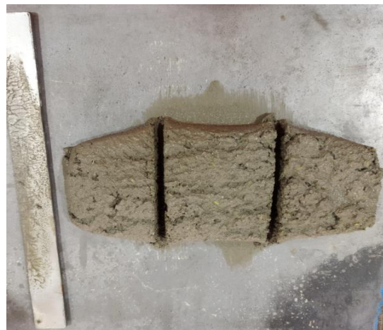
Figure II.7: Pâte de mortier fibré sur une plaque non réactive au ciment et absorbante.
