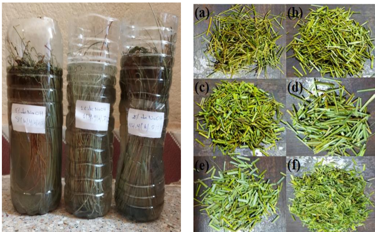
Figure II.4: Traitements chimiques alcalin des fibres par NaOH : a, b et c) fibres d'Alfa après traitement, pour trois différents longueurs ; d, e et f) fibres de Diss après traitement, pour trois différents longueurs.
