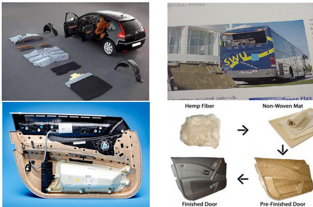
Figure I.17: Application des matériaux composites à base de fibres naturelles dans le domaine d'automobile [43].
