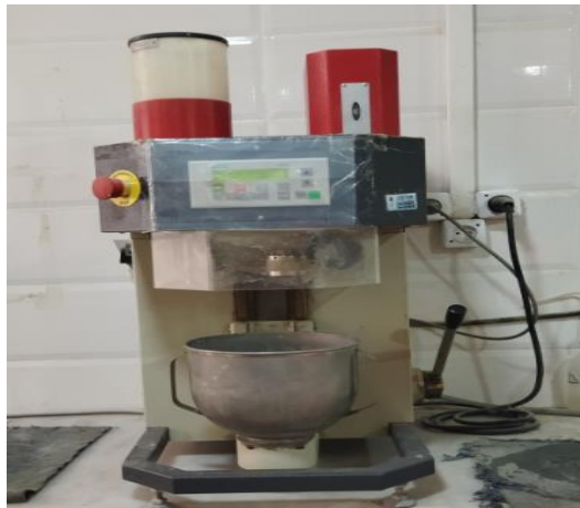
Figure II.6: Malaxeur pour le mélange ciment, sable, eau et former la pâte.
