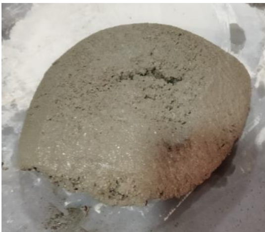
Figure II.7: Pâte de mortier fibré sur une plaque non réactive au ciment et absorbante.
