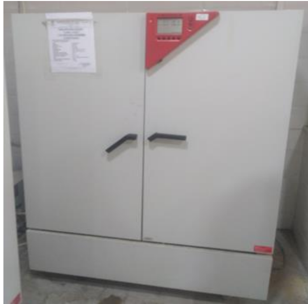
Figure II.12: une chambre climatique.
