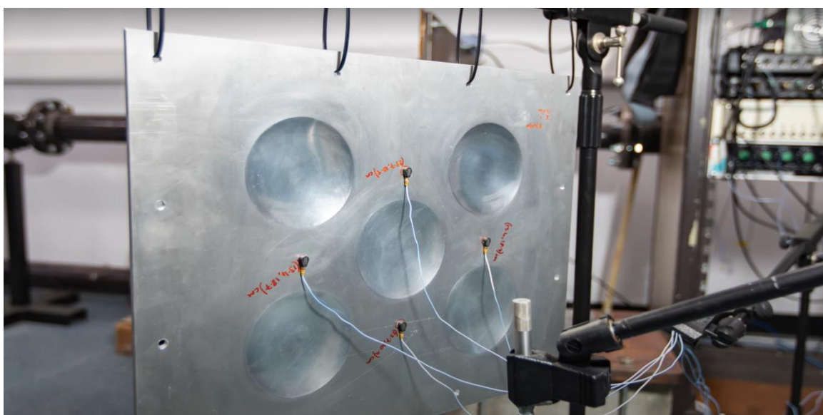
Figure 1.7 : Exemple d'une plaque avec trou noir acoustique de type circulaire.
