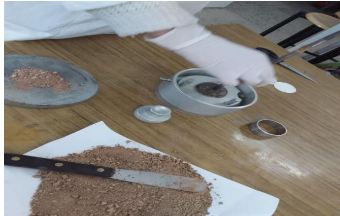
Figure 4.4 Emplacement du sol muni de l'anneau dans la cellule de l'œdomètre
