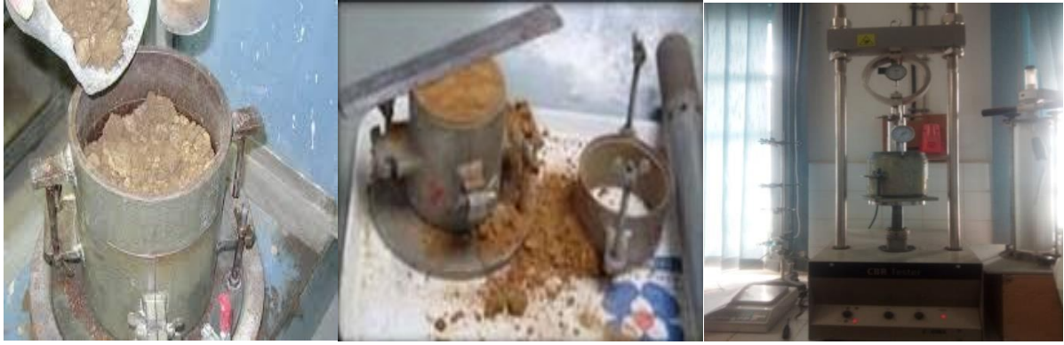
Figure 3.23 Réalisation de l'essai CBR.
