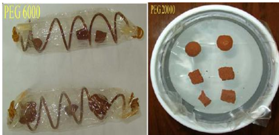
Figure 2.24 Présentation de l'essai pour les deux PEG, selon Bendi ouis A, 2005.
