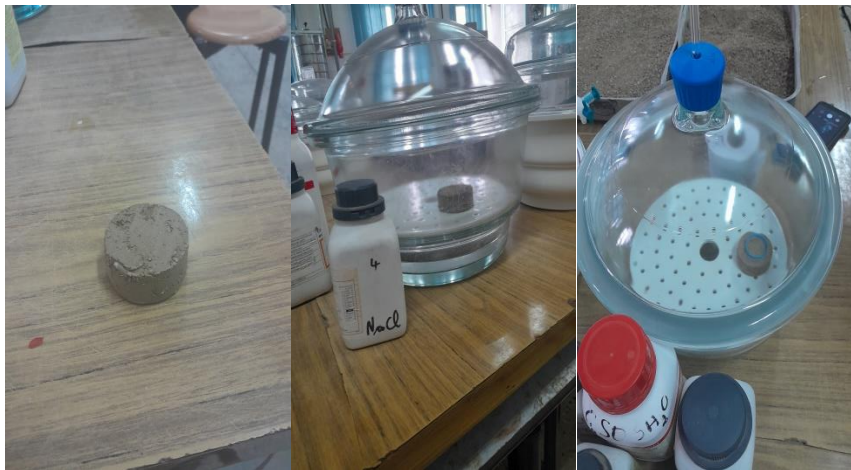
Figure 4.26 Échantillons sur grille des dessiccateurs avec différentes solution saline.
