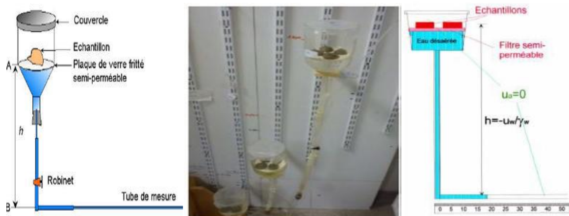
Figure 2.26 Principe de la plaque tensiométrique (Fleureau, 2005).
