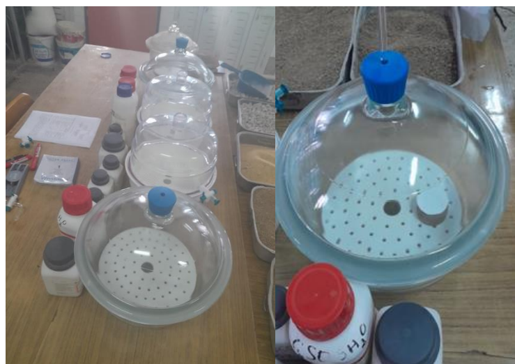
Figure 4.27 Imposition de la succion par phase vapeur à l'aide d'un dessiccateur et de solution saline saturée.
