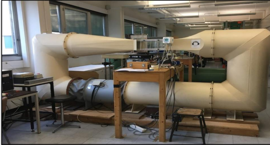
الشكل (5.I) : نفق هوائي ذو دائرة مفتوحة
