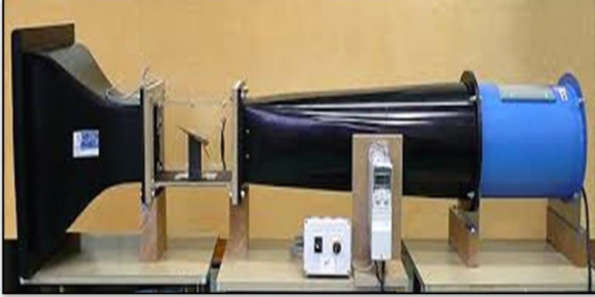
الشكل (5.I) : نفق هوائي ذو دائرة مفتوحة
