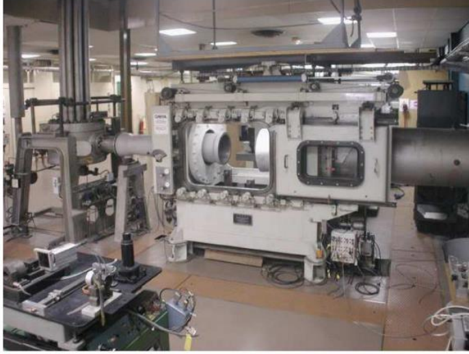
الشكل (4.I) : نفق هوائي فائق للصوت
