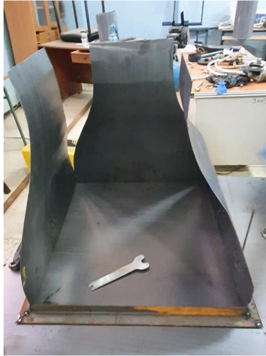
الشكل (7.VI): تركيب أوجه المتقارب داخل الاطار
