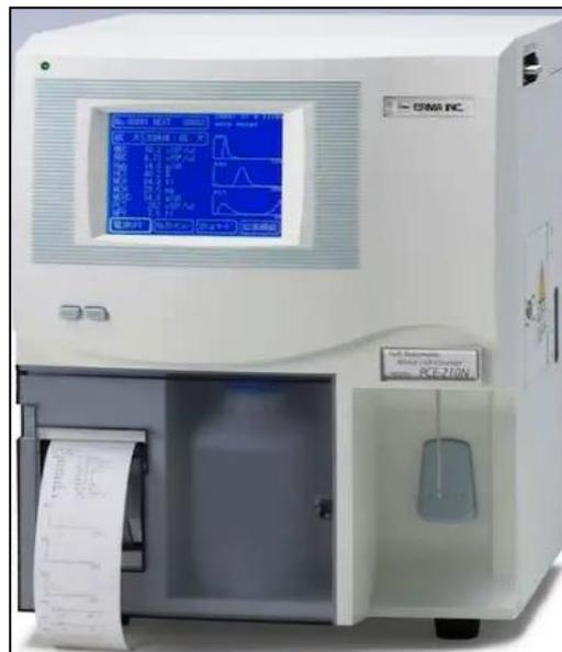
**Figure 19:** Analyseur ERMA INC pour la détermination de la FNS
