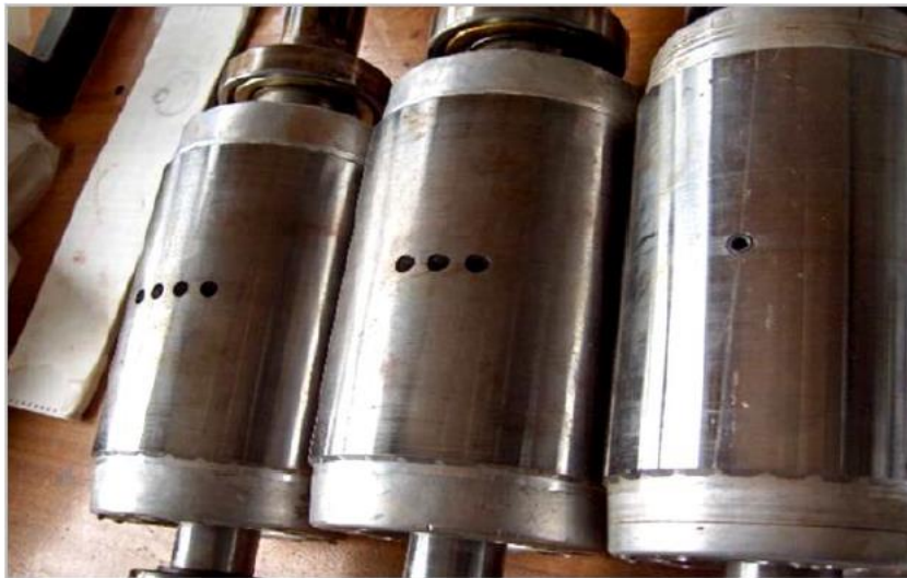
Figure II.1 : Défaut de rupture de barres [55]
